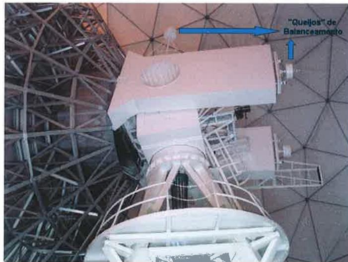
**Figura 10.38:** “Queijos” de ajuste de balanceamento
