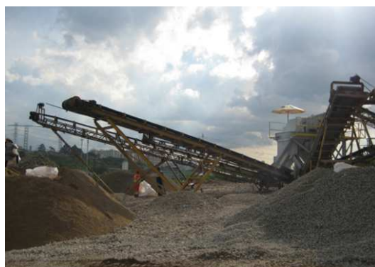
Figura 2.6 - Esteiras rolantes que levam o material às pilhas
