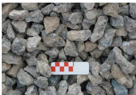
Figura 2.8 - Fração "pedra 2" obtida após britagem primária
