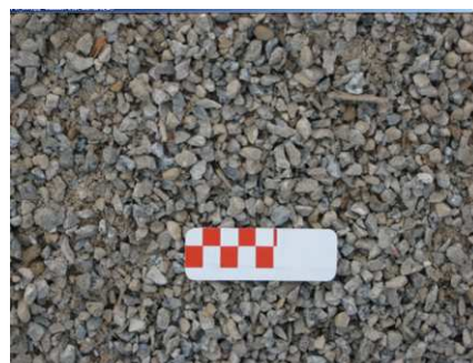
Figura 2.10 - Fração "pedrisco com areia" obtida após britagem primária
