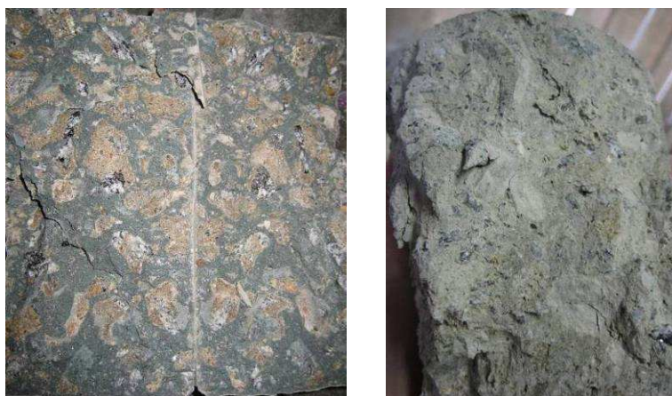
Figura 4.34 - Plano de ruptura dos corpos de prova de concreto contendo agregados reciclados
