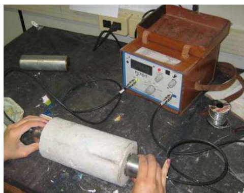
Figura 4.14 - Obtenção do módulo de elasticidade através da leitura do tempo de transmissão de onda no CP
