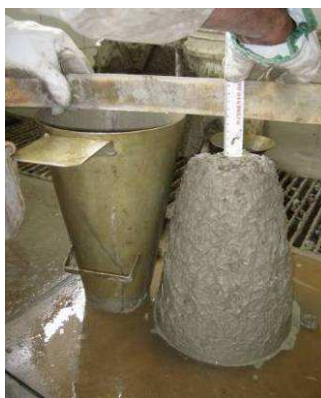
Figura 4.4 - Determinação da consistência do concreto pelo abatimento do tronco de cone
