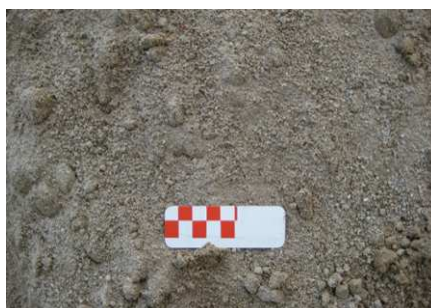
Figura 2.11 - Fração "areia" obtida após britagem primária
