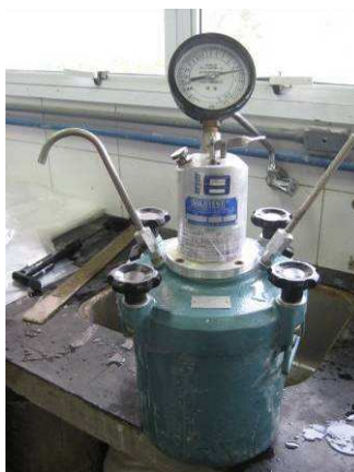
Figura 4.5 - Recipiente de medida de teor de ar incorporado
