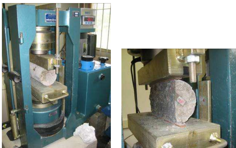
Figura 4.7 - Ensaio de tração por compressão diametral
