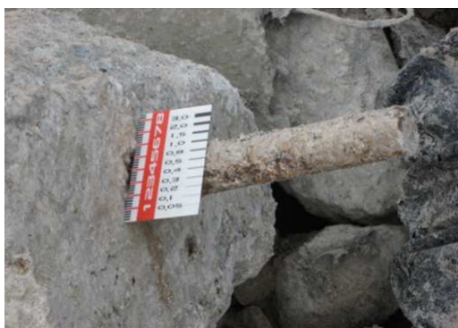
Figura 2.3 - Barra de transferência
