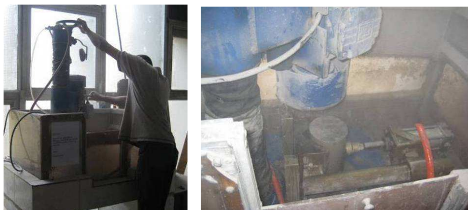
Figura 4.8 - Retificação dos corpos de prova cilíndricos para ensaio de compressão direta
