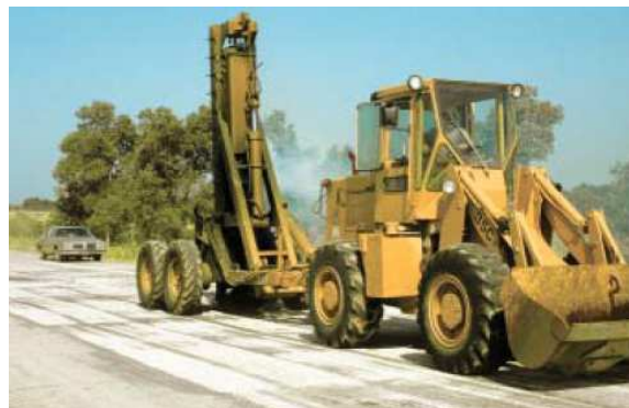
Figura 1.9 - Martelo a diesel montado em trailer (ACPA, 2009)
