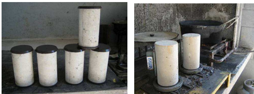
Figura 4.9 - Capeamento de corpos de prova cilíndricos para o ensaio de módulo de elasticidade à compressão com mistura de enxofre
