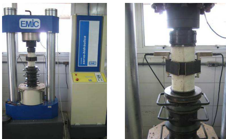
Figura 4.10 - Prensa servo-hidráulica e montagem para o ensaio de módulo de elasticidade à compressão
