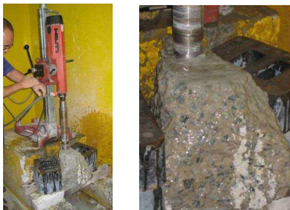
Figura 4.41 - Extração de corpos de prova a partir de blocos de concreto retirados do Rodoanel
