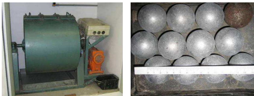
Figura 2.16 - Máquina e esferas metálicas utilizadas no ensaio de abrasão “Los Angeles”
