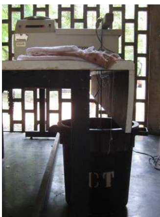
Figura 2.17 - Montagem de equipamento para realização do ensaio de absorção de agregados graúdos
