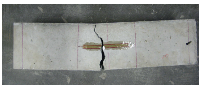
Figura 4.11 - Posicionamento do strain gage no ensaio de tração na flexão
