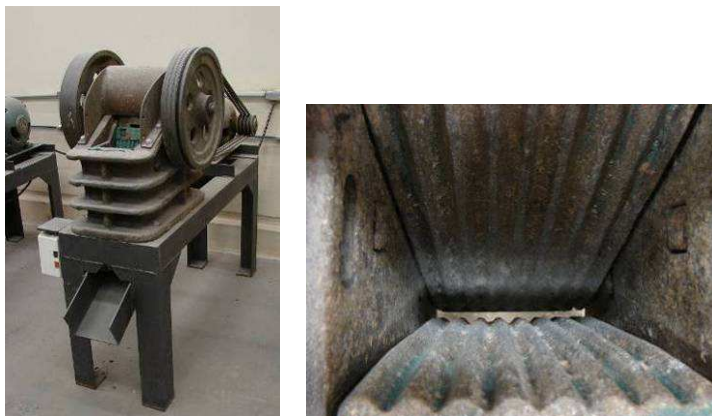
Figura 2.12 - Britador de mandíbula
