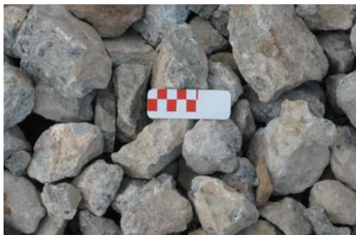
Figura 2.7 - Fração "rachão" obtida após britagem primária
