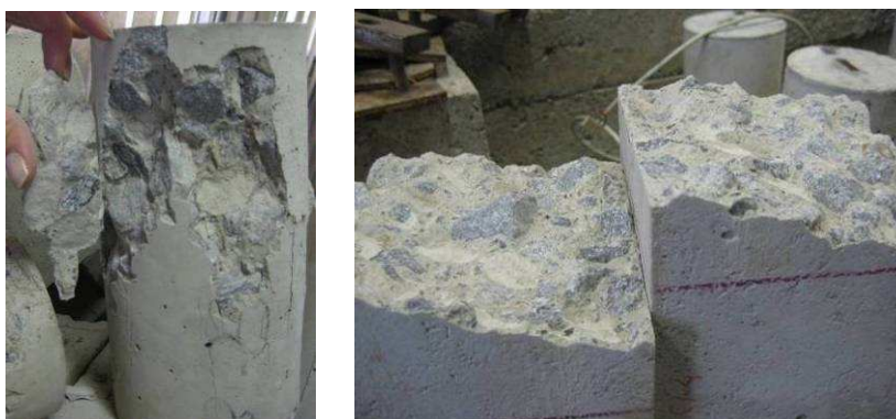
Figura 4.36 - Plano de ruptura dos corpos de prova do concreto convencional
