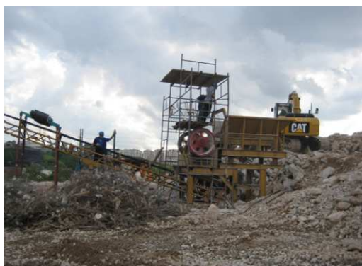
Figura 2.5 - Britador de mandíbula na Britex
