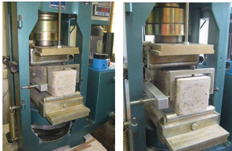
Figura 4.6 - Montagem da prensa para realização do ensaio de 2 cutelos
