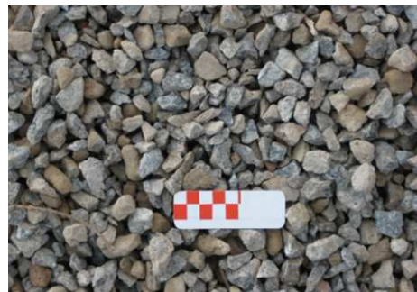
Figura 2.9 - Fração "pedra 1" obtida após britagem primária
