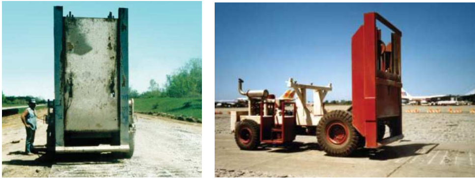
Figura 1.7 - Exemplos de equipamento de martelo por gravidade para quebra de pavimento (ACPA, 2009)
