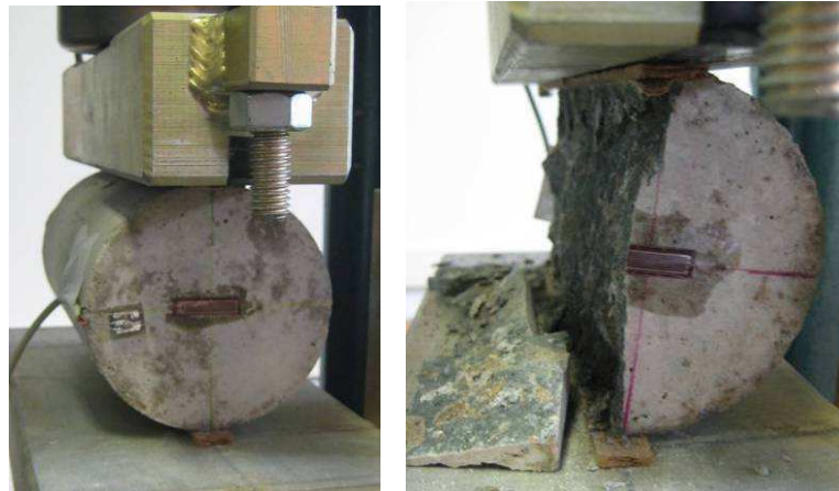
Figura 4.12 - Posicionamento do strain gage no ensaio de compressão diametral
