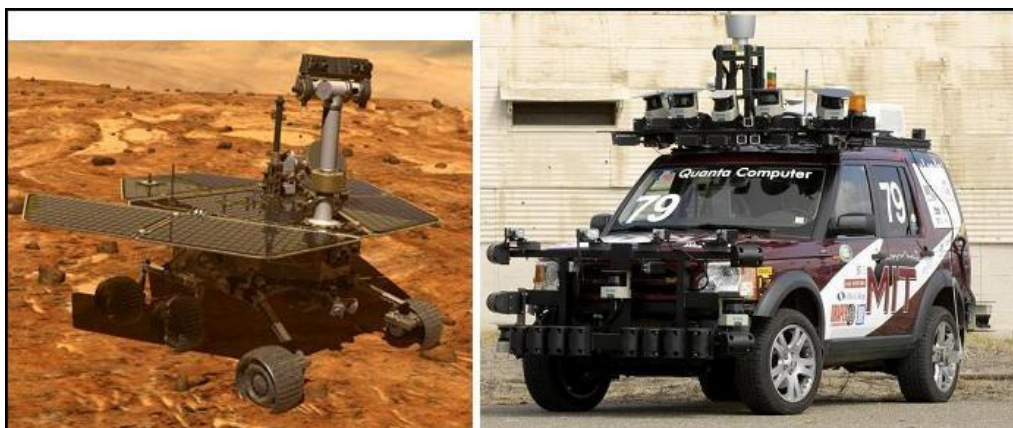
Figura 6 – À esquerda: Veículo Spirit concebido para exploração de Marte. (Fonte: http://static.howstuffworks.com/gif/mars-rover-2.jpg ) À direita: Veículo Talos, concebido para a competição DARPA (Fonte: http://www.hizook.com/files/users/3/MIT_Urban_DARPA.jpg )
