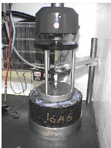
Figura 38 - Ensaio de creep axial sem confinamento com aplicação da carga em área de contato inferior à área do corpo-de-prova
