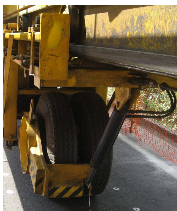
Figura 57 - Semi-eixo acionado por pistão hidráulico
