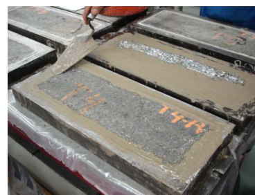
Figura 143 - Confinamento da placa no molde com argamassa.
