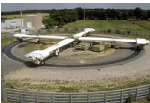
Figura 48 - Mênege de Fatigue – Nantes na França - http://www.lcpc.fr/en/presentation/moyens/manege/index.dml
