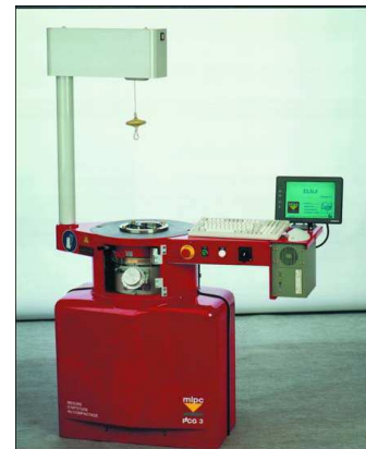
Figura 27 - Prensa de cisalhamento giratório – PCG3
