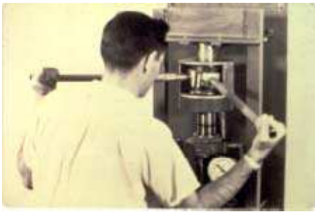
Figura 21 - Compactador Giratório USACE década de 50 http://www.tfhr.gov/pavement/asphalt
