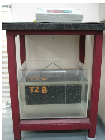
Figura 145 - Pesagem hidrostática das placas de pista
