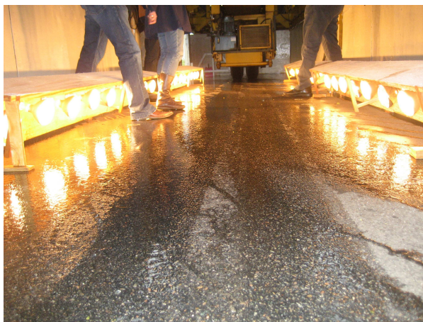
Figura 140 - Sistema de aquecimento e painéis de fechamento do simulador usado nesta pesquisa
