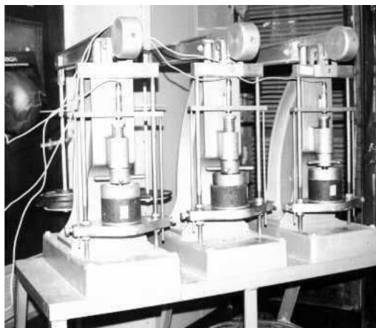
Figura 37 - Ensaio de creep axial sem confinamento com emprego de estrutura para adensamento de solos (SÁ, 1996)
