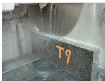
Figura 142 - Corte da altura da placa.
