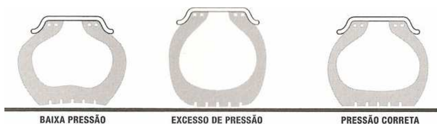
Figura 139- Variação da área de contato em função da pressão de inflagem
