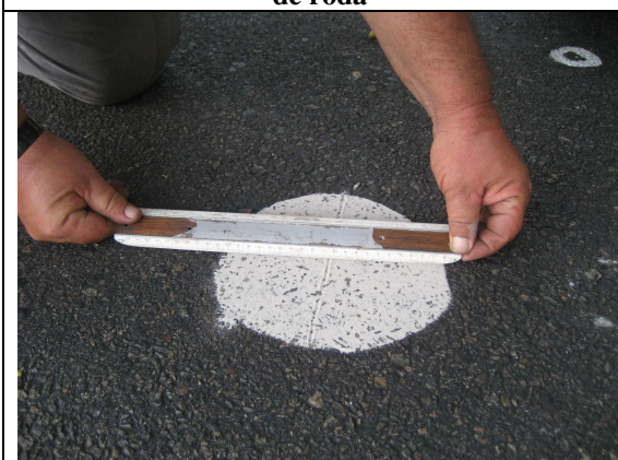
Figura 137 - Macrotextura superficial – ensaio de mancha de areia – HS
