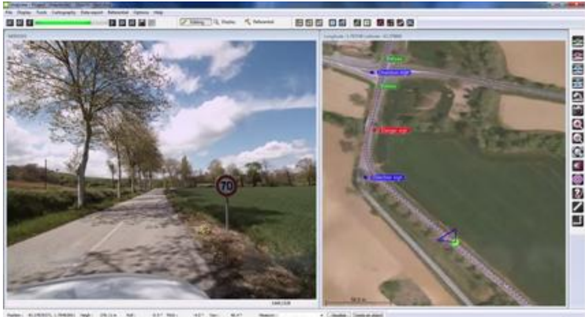
Figura 37 – ImageView: Do lado esquerdo tem-se o vídeo que reconhece e captura placas e do lado direito o posicionamento do veículo com a visada de câmera e placas a serem inventariadas. Fonte:
