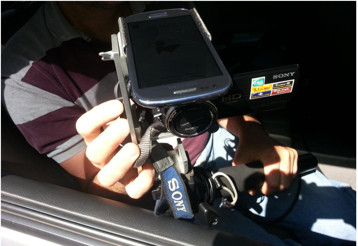
Figura 67. Câmera manual Sony em tomada oblíqua, à qual se acoplou um smartphone com aplicativo AntiMap-Log para a coleta do azimute da visada.
