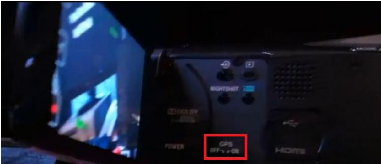
Figura 52 – Detalhe em vermelho do acionamento do receptor GNSS embarcado na câmera manual Sony HD (alta definição).
