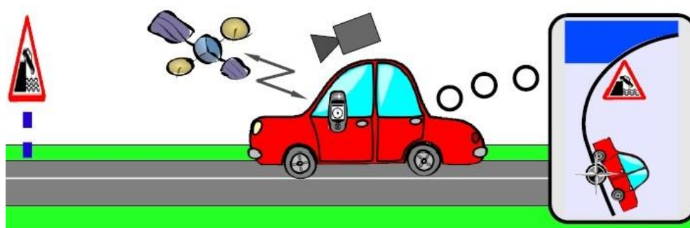
Figura 64: Vídeo georreferenciado para inspeção de segurança de estrada baseada na geoinformação do inventário de tráfego. Adaptado de Segvic et al. (2011).
