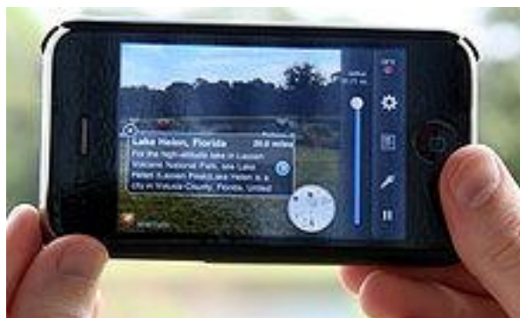
Figura 6 – Aplicativo de Navegação Wikitude sobre o iPhone 3GS, que usa o receptor GNSS e uma bússola digital embarcados.
