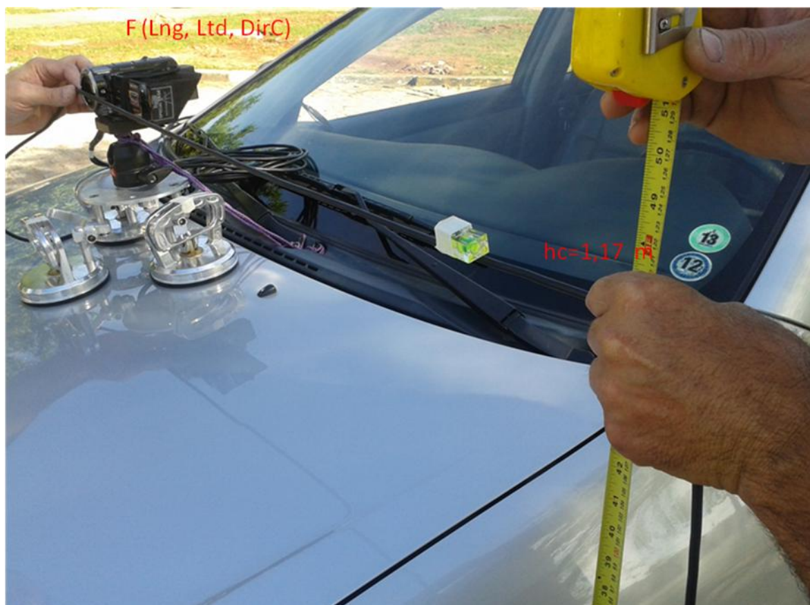
Figura 77- Alinhamento e medida da altura da câmera em relação à via.
