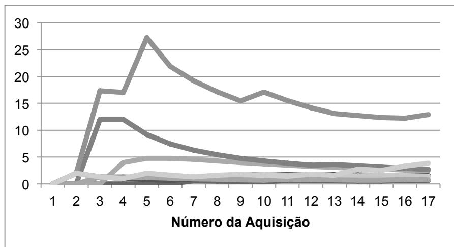
A Figura 22 mostra o mesmo processo de estabilização, porém no local I, que precisou de 64 aquisições para estabilizar. Esse caso específico, uma das redes teve um saldo na variação indo de 1 para 102 entre a sexta e a sétima aquisição, isso causou um atraso no processo inteiro de estabilização.
