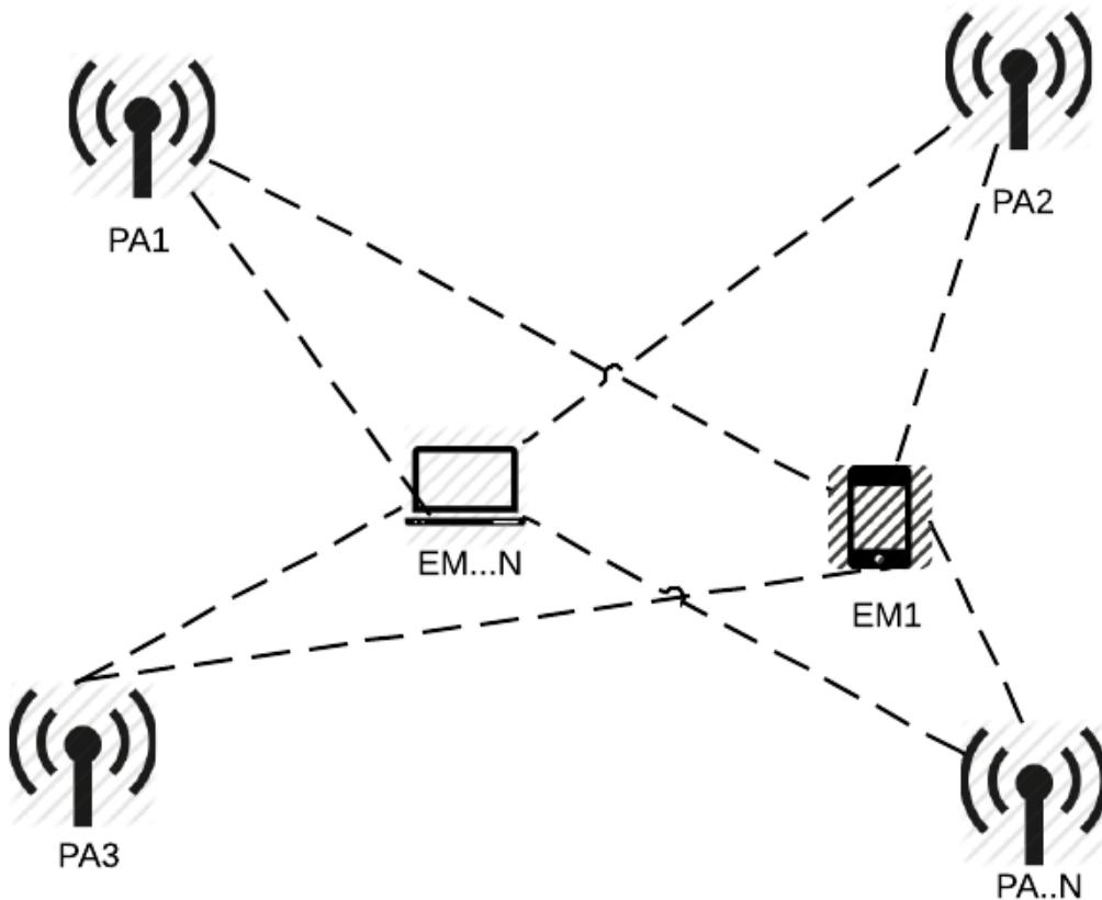
O RSSI é um indicador da força, ou potência, do sinal de rádio recebido pelo receptor. O número geralmente é representado com sinal negativo, e seu módulo varia de 0 a 100, dependendo do fornecedor do equipamento receptor. Importante notar que o RSSI não é a força em decibéis do sinal de rádio.
