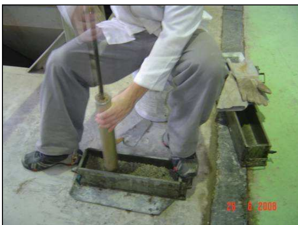
Figura 27 – compactação da primeira camada de CCR - Al em corpo-de-prova prismático
