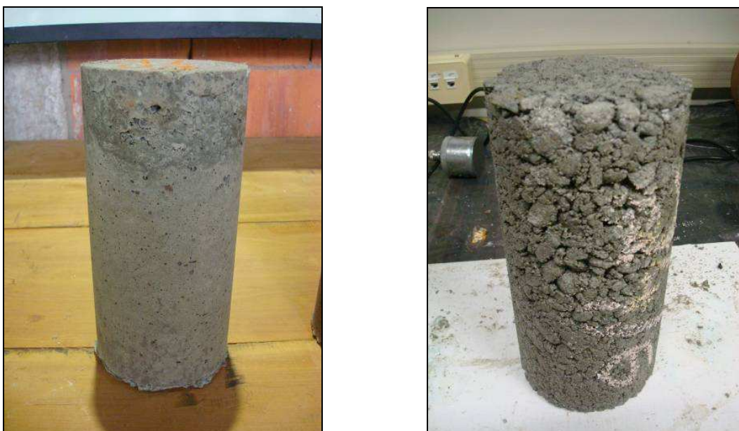
Figura 65 – homogeneidades de misturas de CCR – AI compactadas na umidade de compactação (esq.) e no ramo seco (dir.)
