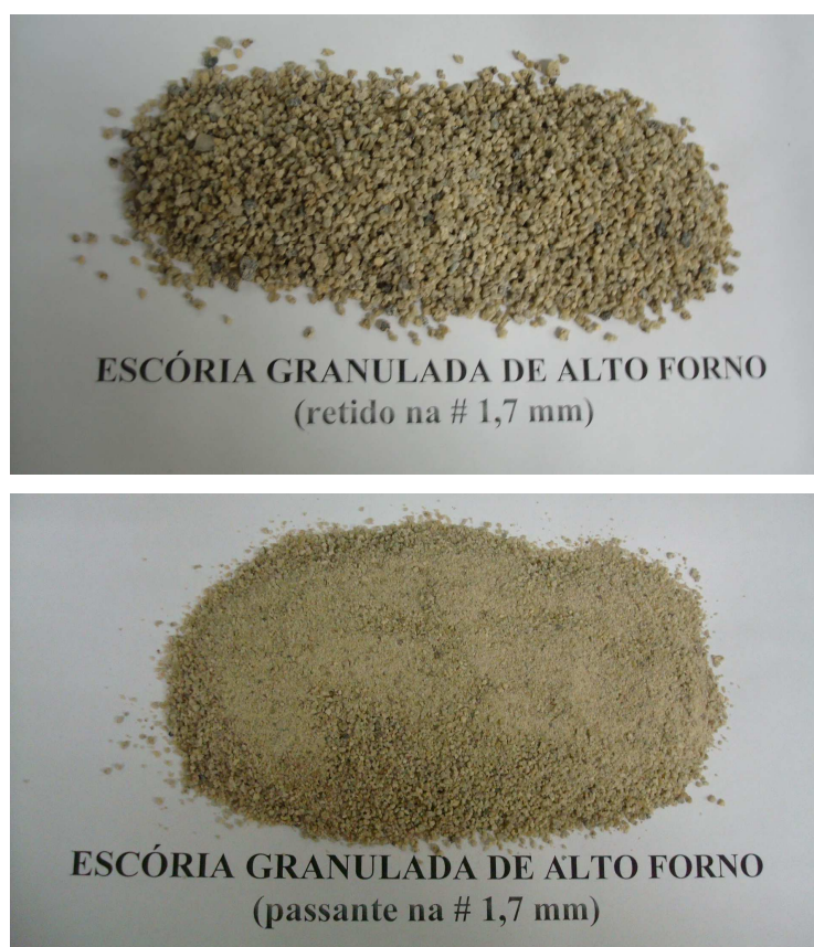
Figura 21 – escória granulada de alto forno após desgaste sofrido no ensaio de abrasão
