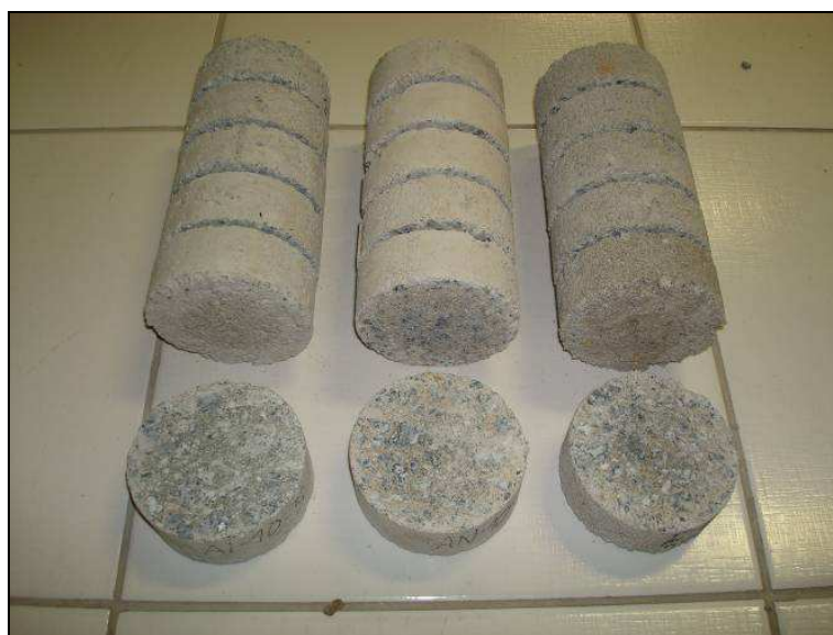
Figura 34 – fatiamento de corpos de prova de CCR para investigação do grau de compactação das camadas
