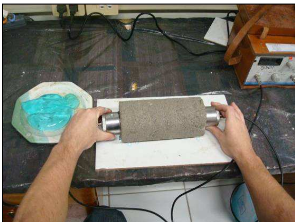
Figura 45 – obtenção do módulo de elasticidade dinâmico em corpo-de-prova cilíndrico (CCR – AI)
