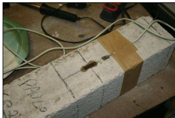
Figura 41 – strainage fixado na face inferior do CCR - AN (em relação à aplicação de carga)
