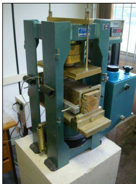
Figura 36 – adequação da prensa para ensaio de tração na flexão (inclusive com LVDT e straining )
