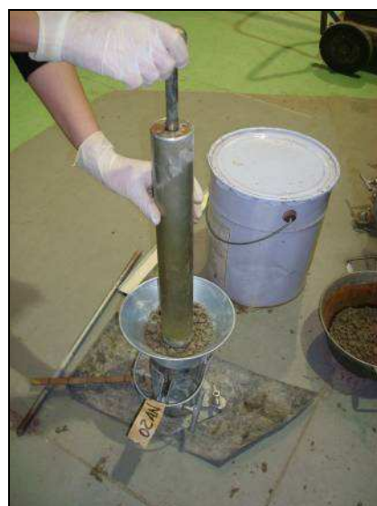
Figura 28 – compactação da última camada de CCR - AN em corpo-de-prova cilíndrico
