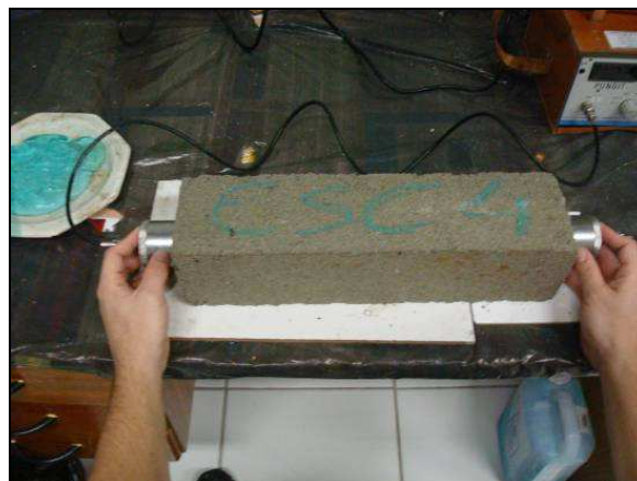
Figura 46 – obtenção do módulo de elasticidade dinâmico em corpo-de-prova prismático (CCR – ESC)
