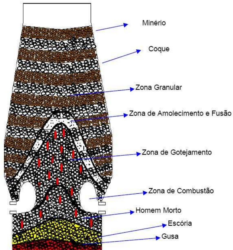
Figura 1 - esquema da parte interna do alto forno (zonas de amolecimento e fusão e de gotejamento)
