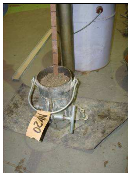
Figura 32 – controle da altura de camada de compactação em corpo de prova cilíndrico
