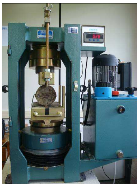
Figura 35 – adequação da prensa para ensaio de tração indireta (inclusive com straining )
