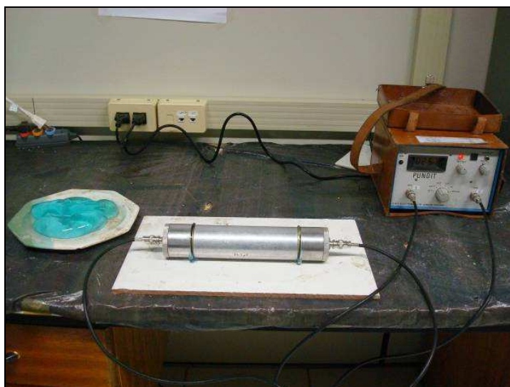
Figura 44 – calibração do equipamento pundit para obtenção do módulo de elasticidade por pulso ultrassônico
