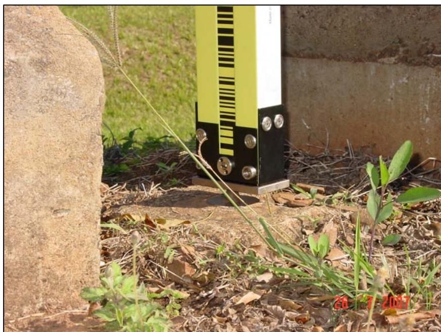
Figura 4.7 – Suporte de instalação da mira no marco.
