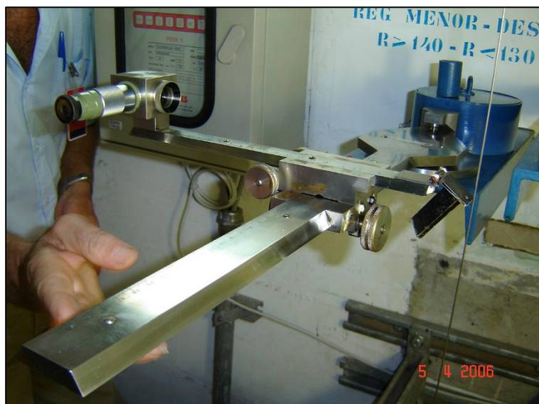
Figura 2.5 - Leitura do pêndulo direto na barragem de ITAIPU com coordenômetro ótico
