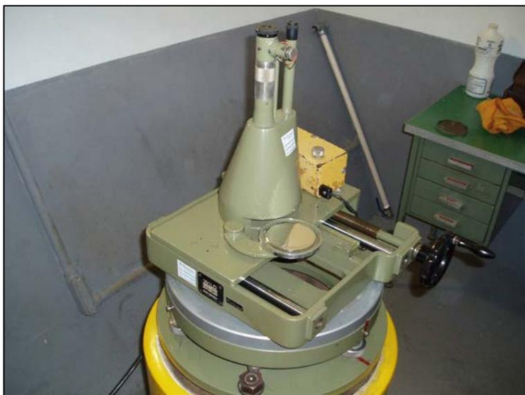
Figura 2.6 - Prumo ótico instalado na barragem de Funil (em arco).
