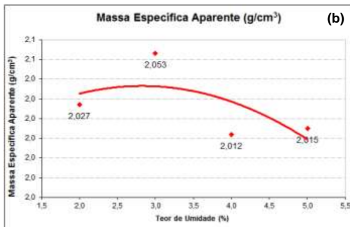
Figura 13 – Resultado das medidas de volume de vazios (a) e massa específica aparente (b), dosagem Marshall – versus teor de umidade
