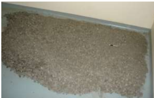
Figura 6 – Espalhamento dos agregados fresados em laboratório
