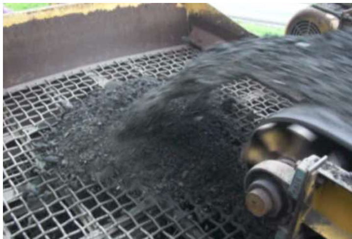
Figura 53 – Seleção granulométrica de agregados
