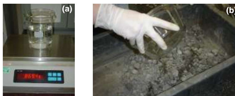
Figura 14 – Pesagem (a) e Adição de água na mistura reciclada (b)
