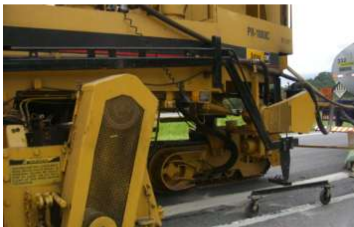
Figura 51 – Sensores laterais de nivelamento
