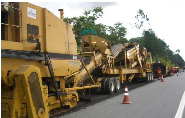
Figura 55 – Adição de emulsão no tanque de misturação final
