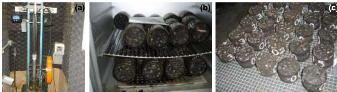
Figura 11 – Compactação (a) e cura dos corpos-de-prova (b) e (c)
