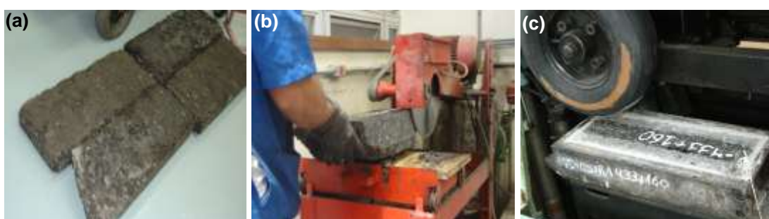
Figura 66 – Placas extraídas do trecho experimental (a), faceadas (b) e ensaiadas no simulador de tráfego tipo LPC de laboratório (c)
