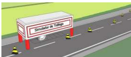
Figura 73 – Simulador de Tráfego instalado na Faixa II – desvio de tráfego
