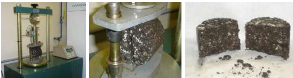
Figura 23 – Ensaio de resistência à tração por compressão diametral
