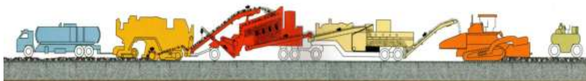
Figura 4 – Sequência de equipamentos para a reciclagem a frio in situ com trem de reciclagem (Fonte: Brown&Brown, 2009)
