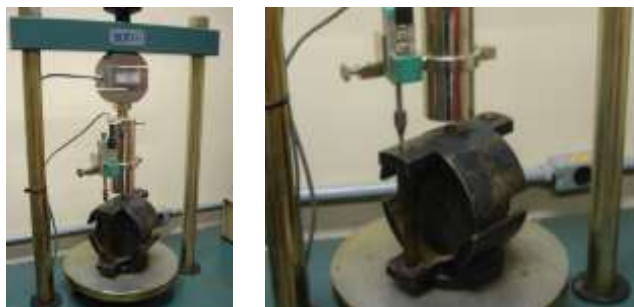
Figura 21 – Equipamento e ensaio de estabilidade
