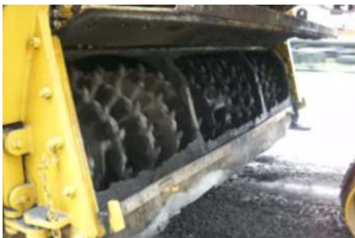
Figura 49 – Cilindro fresador com 3,6 metros de largura
