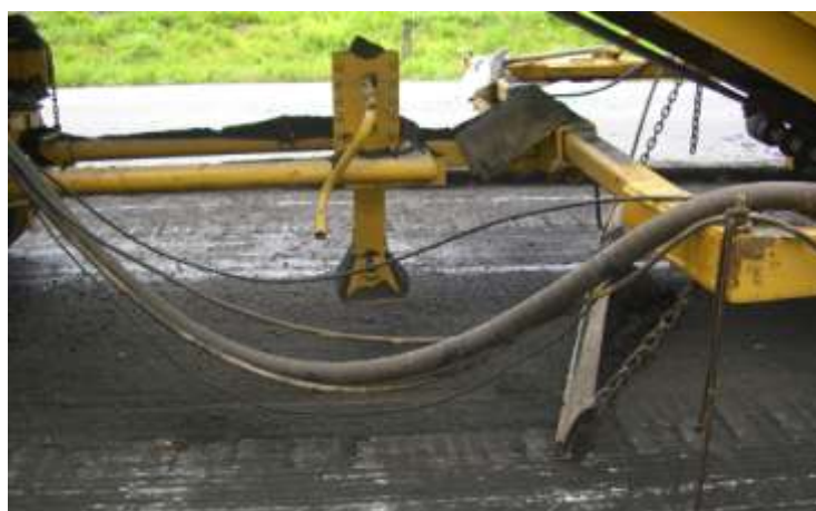
Figura 52 – Rodo para arraste e distribuição de agregados soltos
