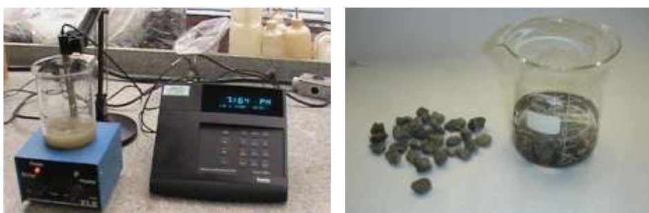
Figura 7 – Peagâmetro na determinação do pH com agregados graúdos e finos
