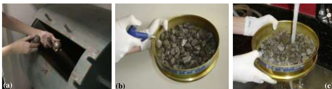
Figura 8 –Ensaio de abrasão Los Angeles (a) para agregados fresados, livres de pó (b) e lavados (c)
