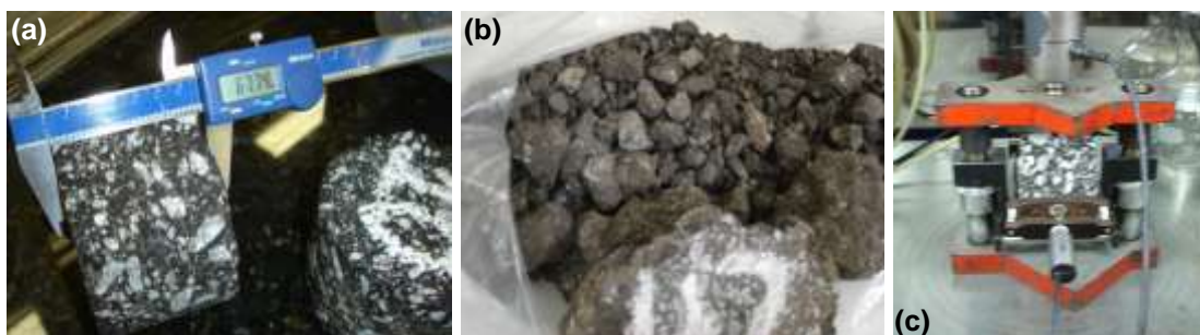
Figura 65 – Corpos-de-prova submetidos a medidas de densidade (a), ensaio Cântabro (b) e ensaio de Módulo de Resiliência (c)
