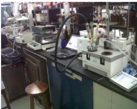
**Figura 3.3** - Foto ilustrativa do reator Easymax integrado com a sonda de infravermelho.
