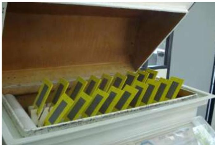
**Figura 3.4** - Foto ilustrativa dos corpos de prova dentro da câmara de névoa salina e com as bordas protegidas com fita adesiva.
