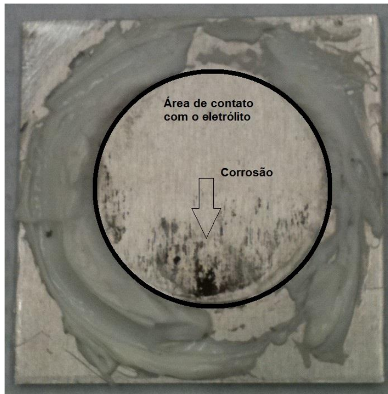
Figura 4.35 - Imagem da liga AA2024-T3, com revestimento híbrido não modificado, após 08 semanas de imersão em solução de Harrison.
