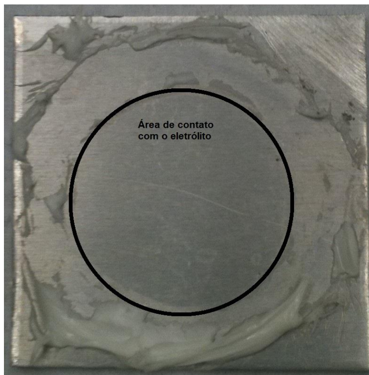
Figura 4.36 - Imagem da liga AA2024-T3, com revestimento híbrido modificado com 0,005M de HEDP, após 08 semanas de imersão em solução de Harrison.
