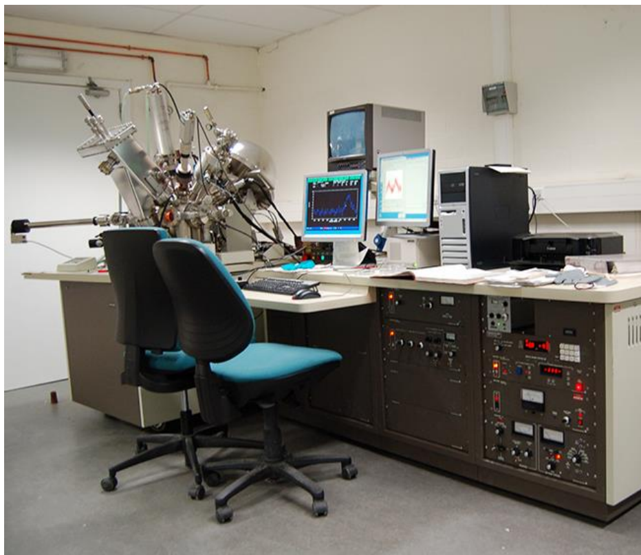
Figura 3.5 - Equipamento de XPS utilizado durante as análises junto ao laboratório de eletroquímica e engenharia de superfície da VUB.
