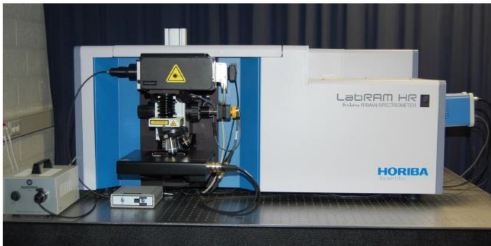
Figura 3.6 - Equipamento de microscopia RAMAN utilizado durante as análises junto ao laboratório de eletroquímica e engenharia de superfície da VUB.
