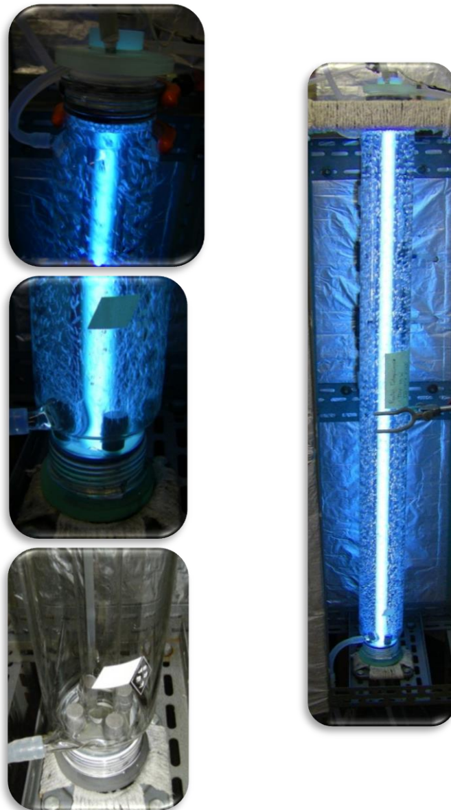
Figura 14 - Reator fotoquímico anular coaxial utilizado no estudo da degradação do herbicida amicarbazona por O_3/UV .
