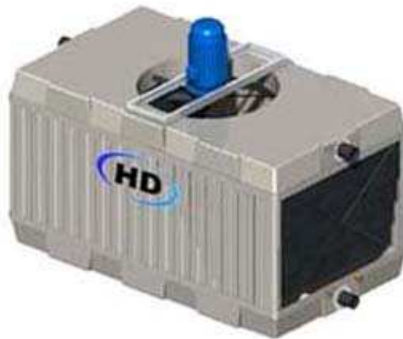
Figura 1.5 - Torre de resfriamento com aspiração mecânica induzida (ventilador na descarga de ar). A saída do ar é em alta velocidade. (HIDROTÉRMICA, 2011)
