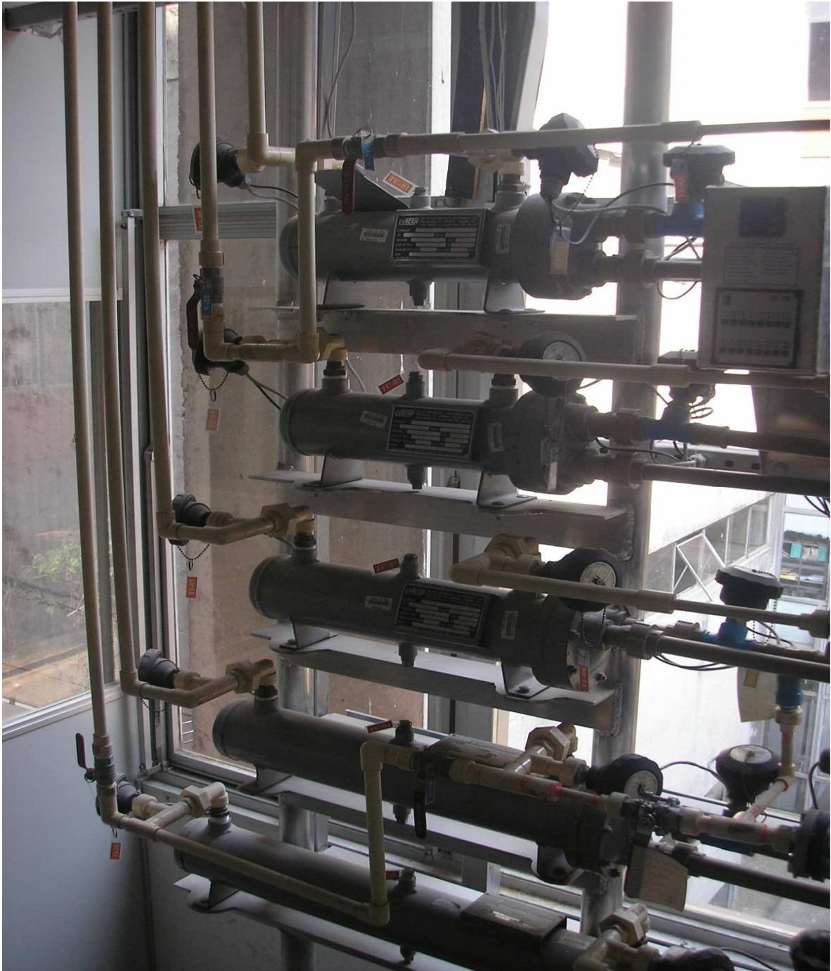
Figura 2.1 - Rede de trocadores de calor. Os trocadores estão ordenados numericamente de TC-01 até TC-05 de cima para baixo. Os trocadores utilizados são os dois primeiros (TC-01 e TC-02).
