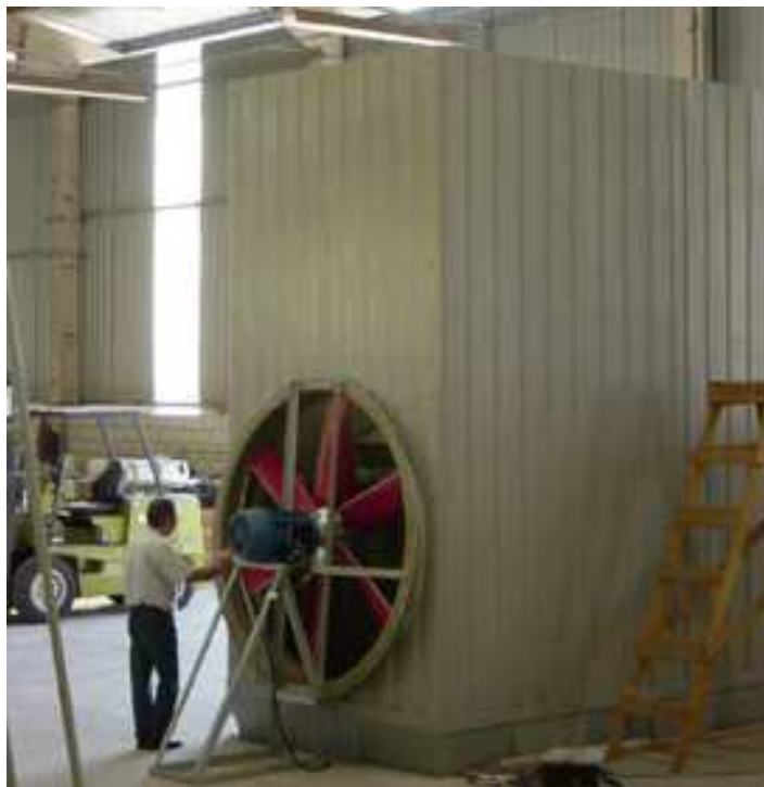
Figura 1.4 - Torre de resfriamento com aspiração mecânica forçada (ventilador na captação de ar). A entrada do ar é em alta velocidade. (COOLING TOWER DESIGN, 2011)
