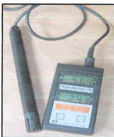
Figura 3.11. Foto do higrômetro.
