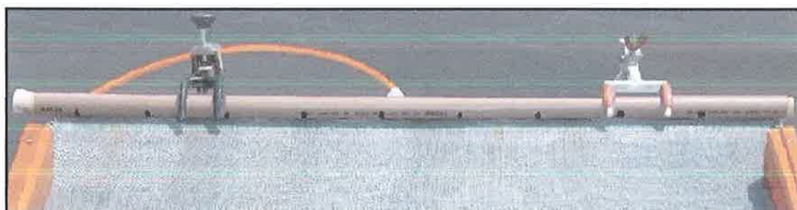
Figura 3.6. Foto do distribuidor de líquidos.
