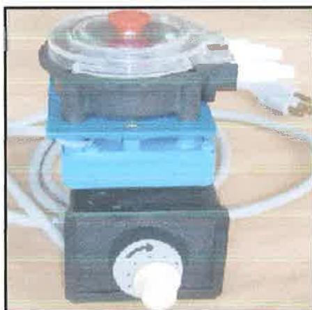
Figura 3.5. Foto da bomba peristáltica.
