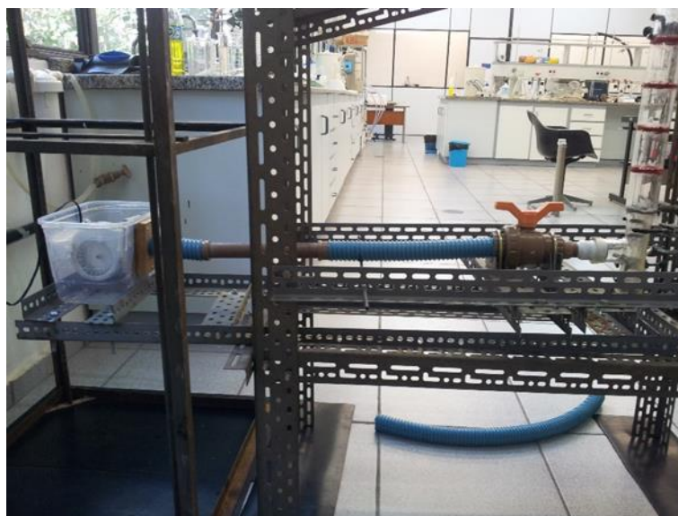
Figura 16 – Linha de entrada da fase gasosa, composta pela turbina, misturador de gases e válvula de esfera
