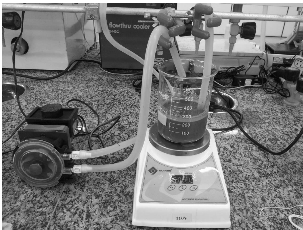
Figura 12 – Teste de bancada para avaliar a homogeneidade da suspensão de cinzas de madeira em água com o auxílio de uma bomba peristáltica dosadora e agitador magnético.
