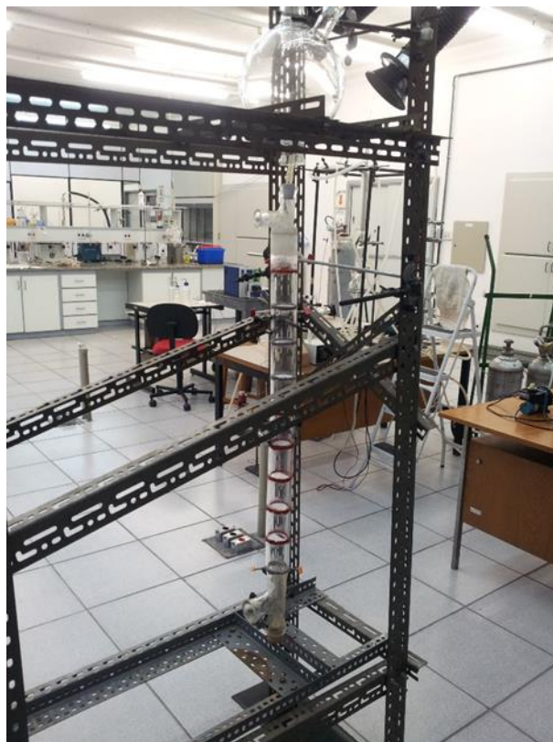
Figura 14 – Protótipo da coluna de absorção de 8 pratos e tanque de armazenamento de suspensão de cinzas, com capacidade de 5 L
