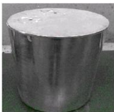
Figura 6 – Fotografia do Recipiente Oxidante do Reator 2 do processo Humifert, fechado, após retirada do suporte, antes das modificações .
