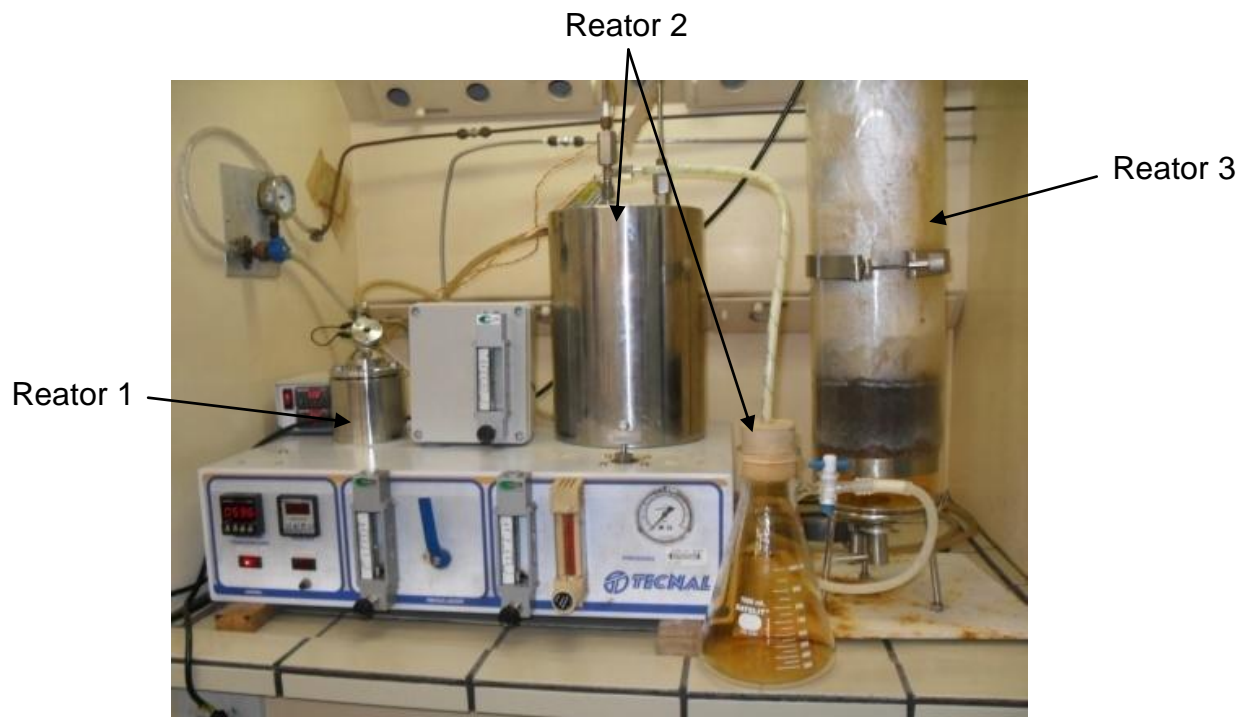
Figura 5 – Fotografia do equipamento para obtenção dos compostos organofosfatados pelo processo Humifert, após modificações.
