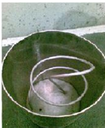
Figura 7 – Fotografia do Recipiente Oxidante do Reator 2 do processo Humifert, aberto, após retirada do suporte, antes das modificações.
