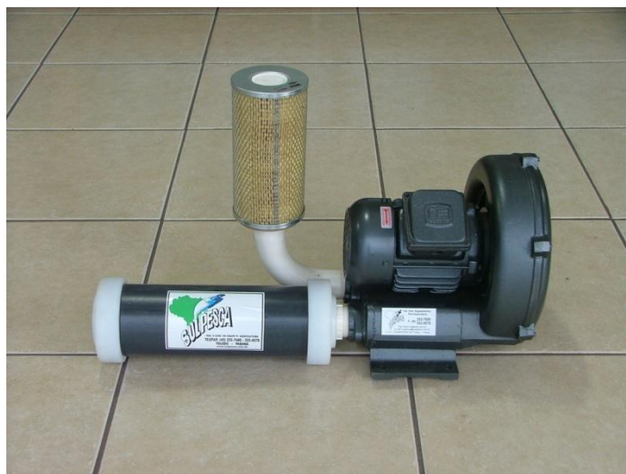
Figura 9 – Fotografia do soprador instalado no processo Humifert, após modificações em substituição ao compressor do equipamento Humifert instalado no IGC..
