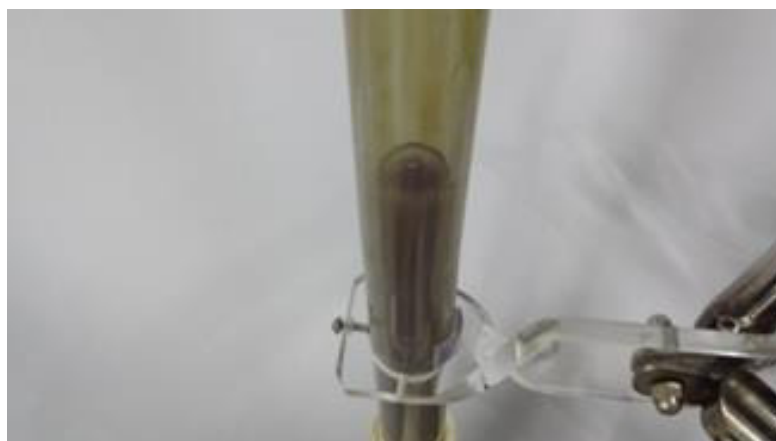
Figura 49 - Tubo injetor de óleo na tubulação de água.
