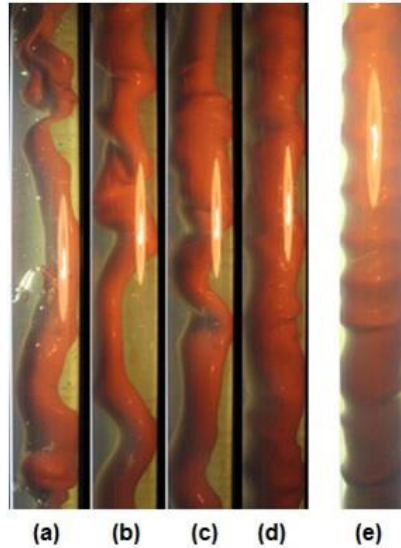
Figura 8 - CAFs formados por diferentes velocidades entre o óleo e a água (Silva et al. , 2014).
