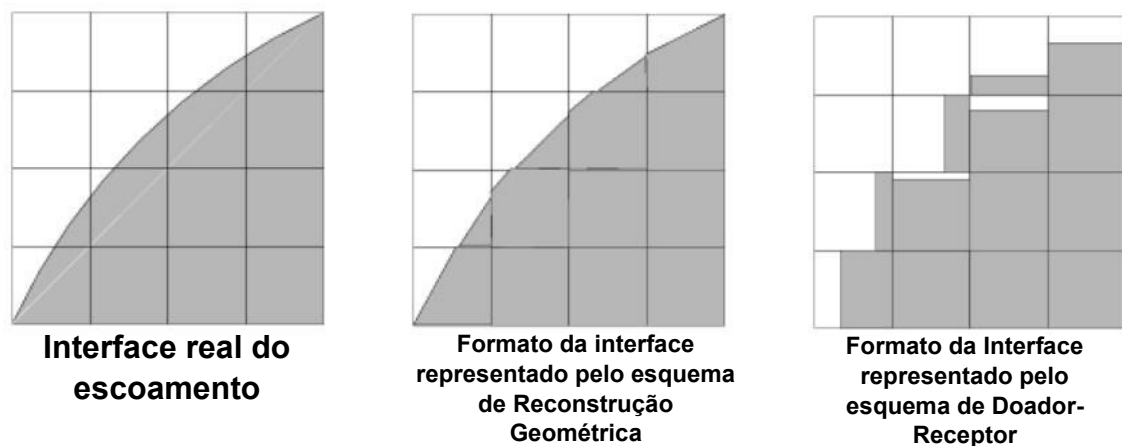
Figura 18 - Esquemas de interpolação na interface. Fonte: Manual de teoria ANSYS (2014)
