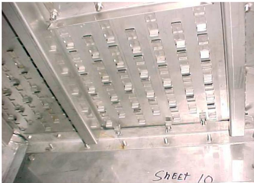
**Figura 2.9** Detalhe de fixação de prato valvulado.
