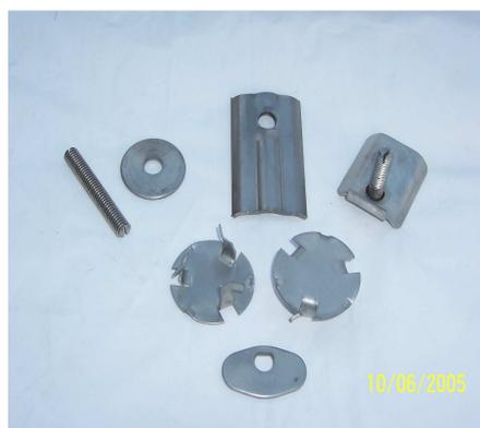
**Figura 2.6** Detalhes de acessórios de montagem de prato valvulado. Fonte: Riemer, 2007.
