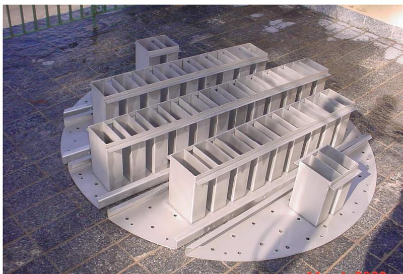
**Figura 2.24** Distribuidor de líquido. Fonte: Riemer, 2007.
