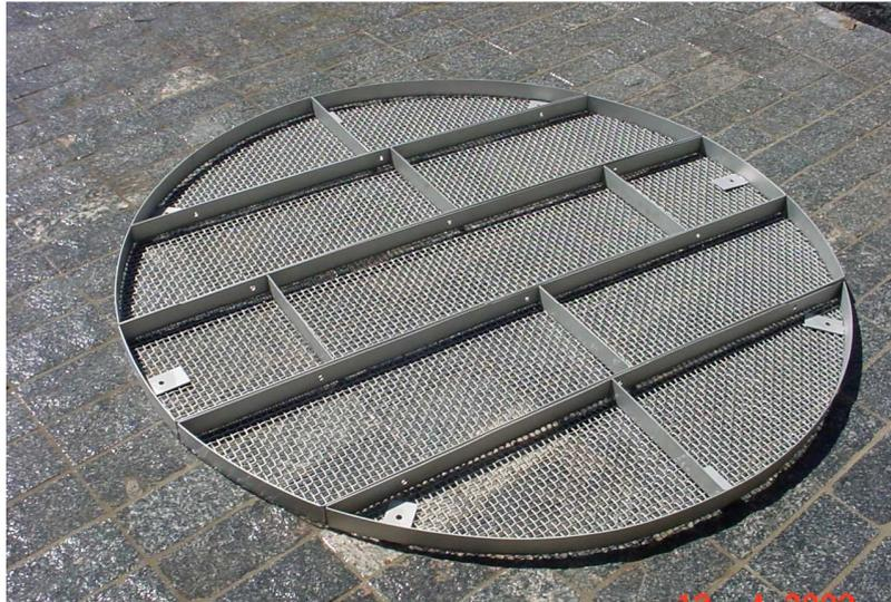
**Figura 2.22** Limitador de leito de recheios aleatórios. Fonte: Riemer, 2007.
