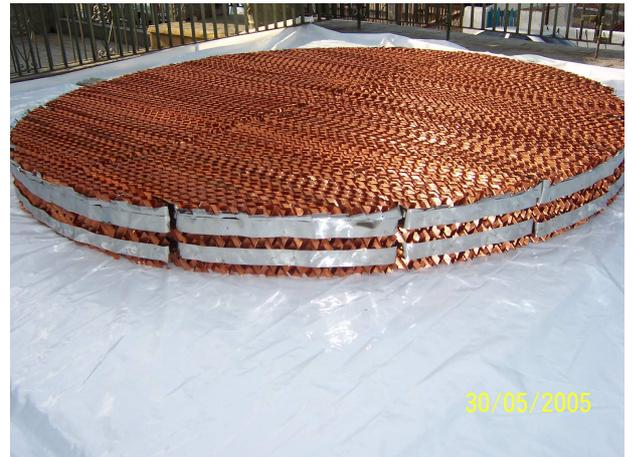
**Figura 2.20** Camada segmentada de recheio estruturado, construída em cobre. Fonte: Riemer, 2007.
