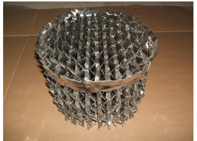
**Figura 2.21** Camadas de recheio estruturado de pequeno diâmetro. Fonte: Riemer, 2007.
