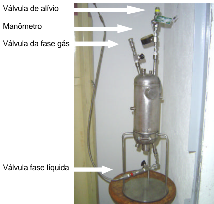
Figura 4-2. Reservatório para transferência de butadieno em aço inox.
