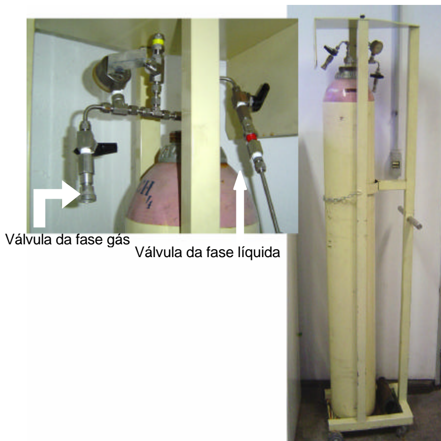
Figura 4-3. Cilindro de armazenagem do butadieno
