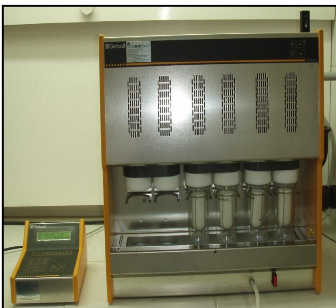
Figura 10 - Extrator automático (Gerhardt, modelo Soxtherm Multistat / SX PC).
