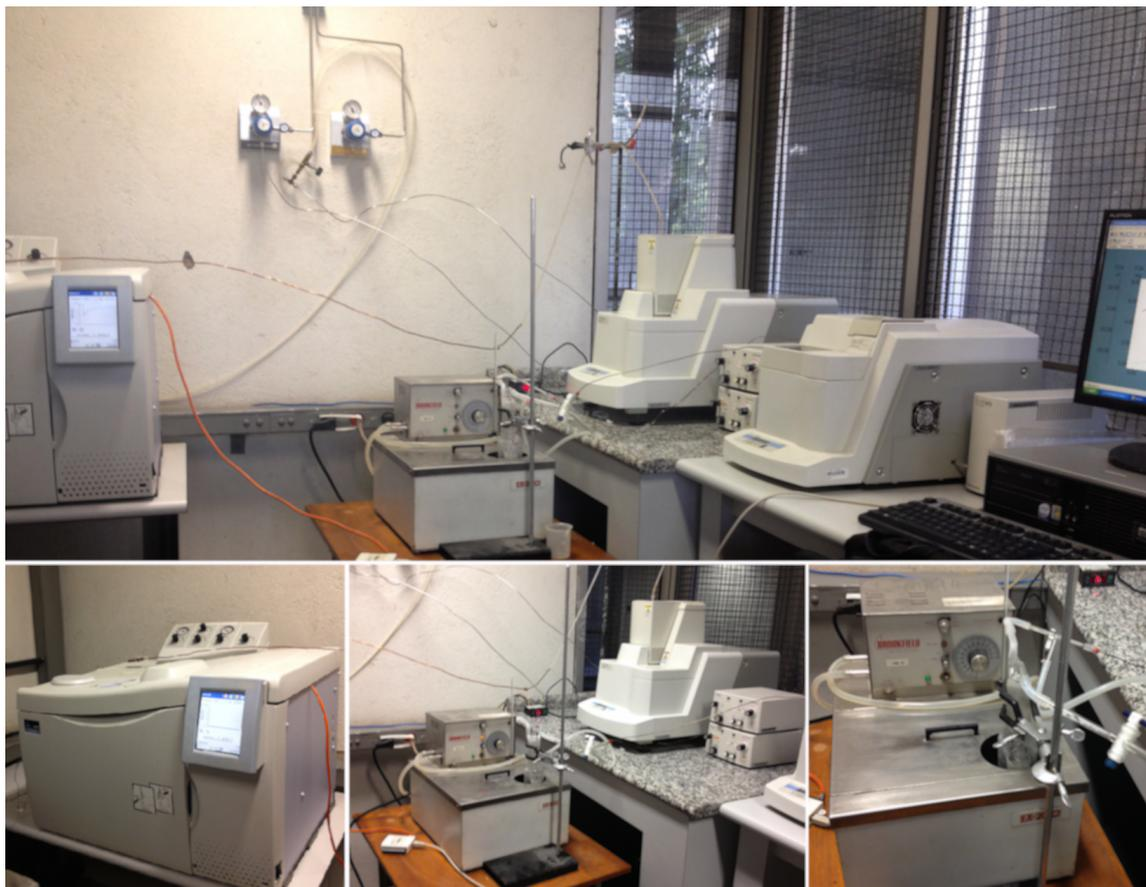
**Figura 3.2:** Elaboração do aparato experimental (TG acoplado a um CG) para a gaseificação de microalgas (por Paulo Moreira e Camila Emilia Figueira - DEQ/USP).
