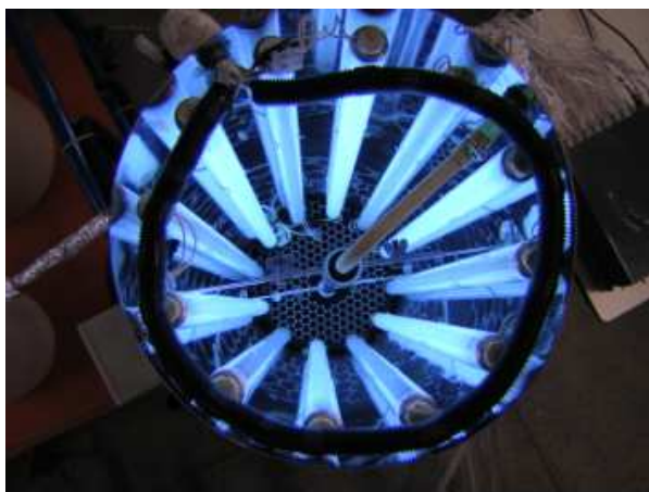
Figura 3.2. Foto das 12 lâmpadas fluorescentes fixadas na parede interna do reator
