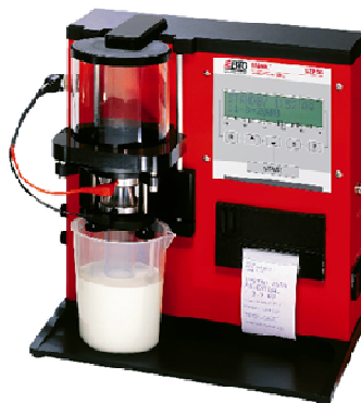
Figura 3.3 – Medidor do potencial zeta Mütek SZP-06 .
