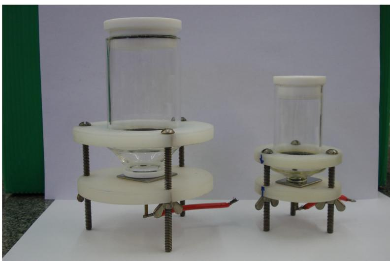
Figura 3.4 - Células eletroquímicas usadas para os estudos de eletrodeposição.
