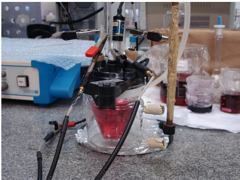
Figura 3.3 - Célula eletroquímica de Tait para os estudos de voltametria.
