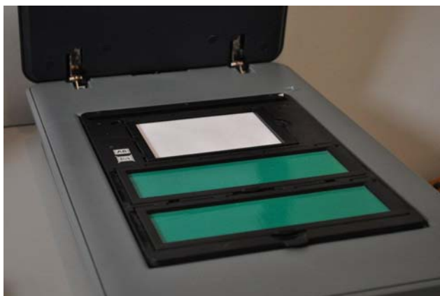
Figura E.4. Amostra (papel branco) disposta no digitalizador de mesa, sob a máscara de suporte (acessório original do digitalizador).
