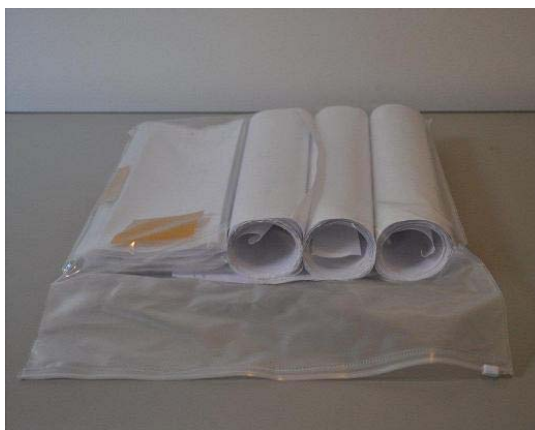
Figura E.2. Faixa de papel de 300 mm x 5300 mm, retirada da bobina jumbo e enrolada e amostras cortadas com dimensões de 100 mm x 300 mm.
