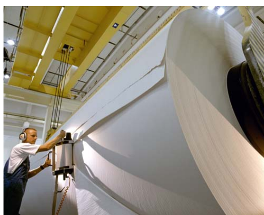
Figura E.1. Coleta de uma faixa de papel ao longo da direção transversal da bobina jumbo, com auxílio do equipamento auxiliar de corte [fonte: Lorentzen & Wettre, 2010 216 ]
