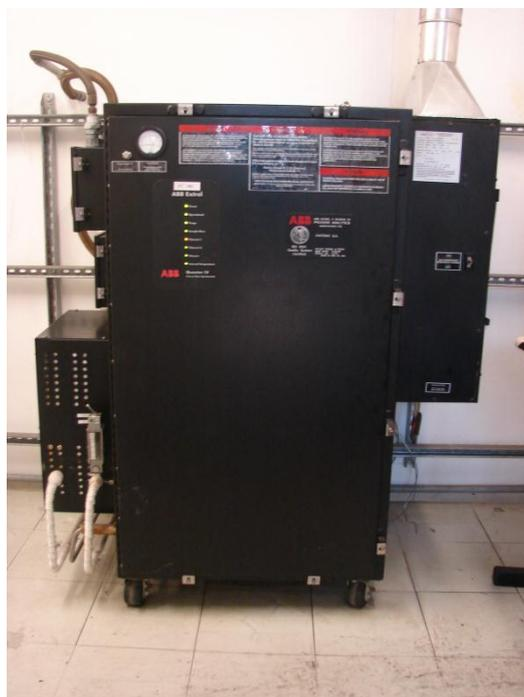
Figura 40 – Espectômetro de massa, modelo Questor IV
