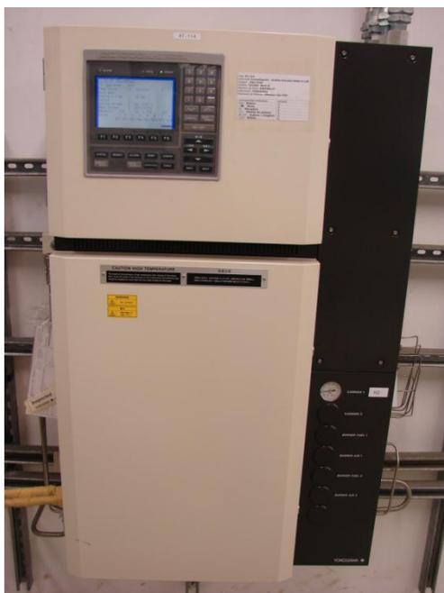
Figura 37 – Cromatógrafo de Processo, modelo CG1000 MarK II
