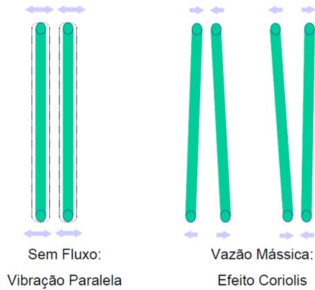
Figura 27 – Simulação do Efeito Coriolis em um medidor de vazão
