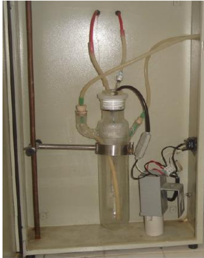
Figura 10 – Reator fotoquímico de imersão com lâmpada de média pressão de vapor de mercúrio Philips HPLN.
