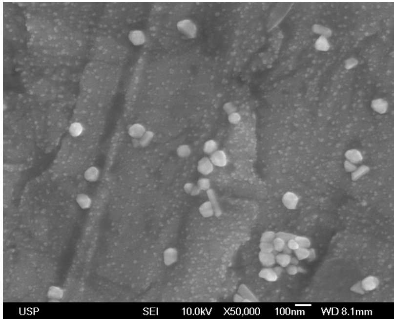
Figura 13 - Nanopartículas em estágio intermediário da reação, geradas a 95 °C e pH 7, 40 minutos de reação.
