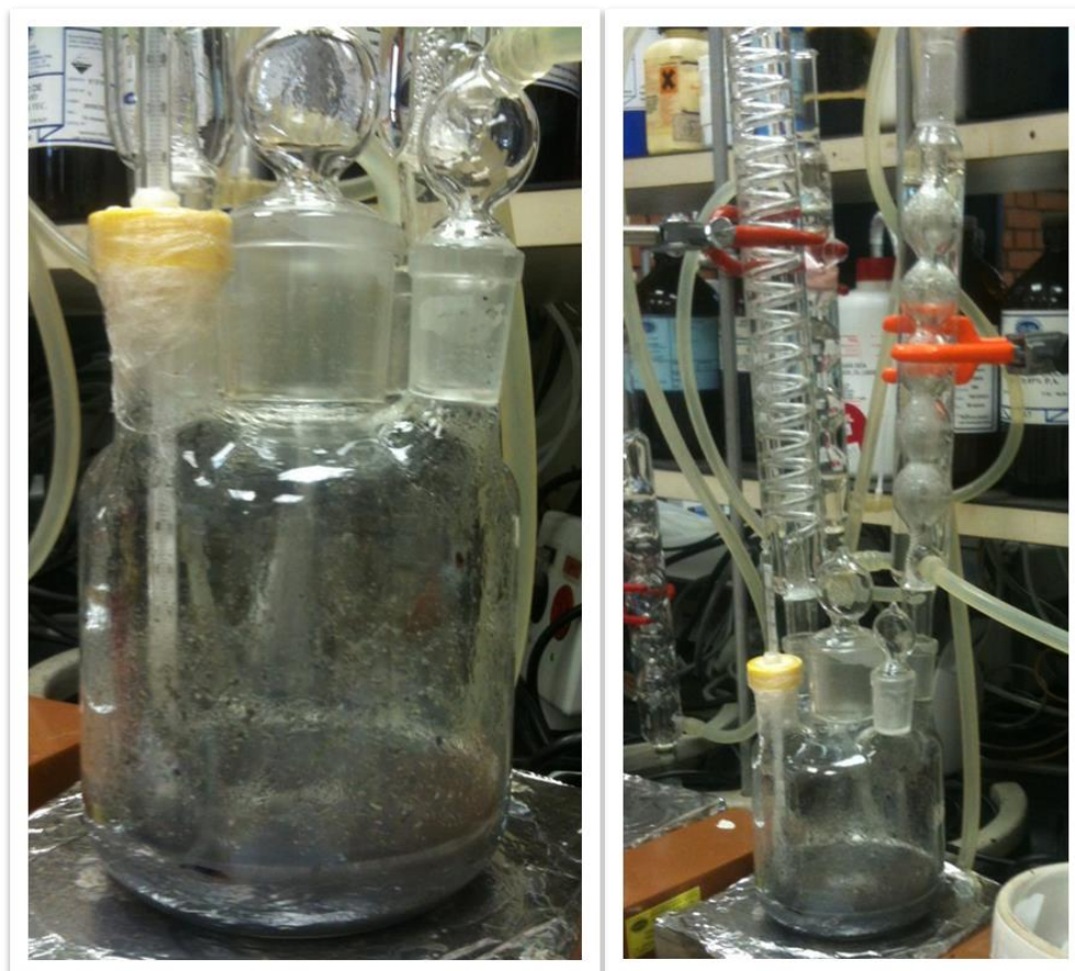
Figura 21 - Esquema do balão de fundo chato e cinco bocas utilizado no processo de lixiviação ácida. No detalhe à esquerda, o termômetro mergulhado na solução.
