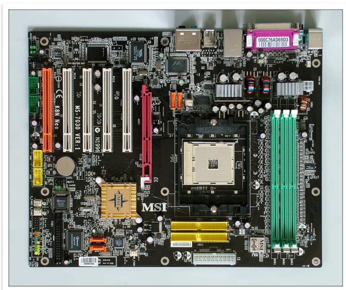
Figura 16 – Vista superior da placa-mãe de computador pessoal de mesa, sem os componentes acessórios à placa.
