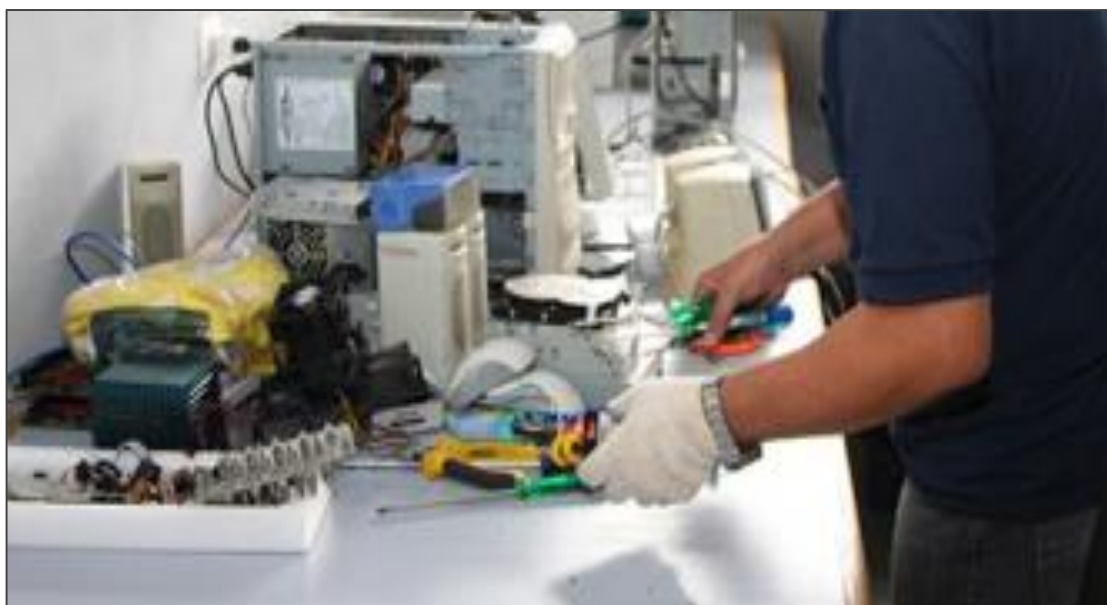
Figura 10 - O desmantelamento manual de placas de circuito impresso traz diversos benefícios ao processo de tratamento dos REEE (CEDIR, 2011).
