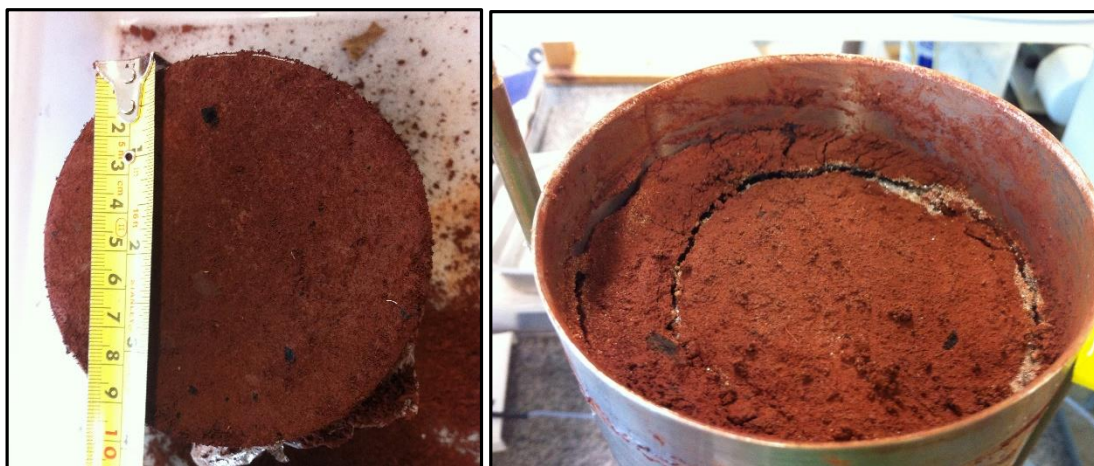
Figura 49 – Coluna 2 pré oxidação na base da coluna (esquerda) fissuras no solo da Coluna 2 pós oxidação no topo da coluna(direita).
