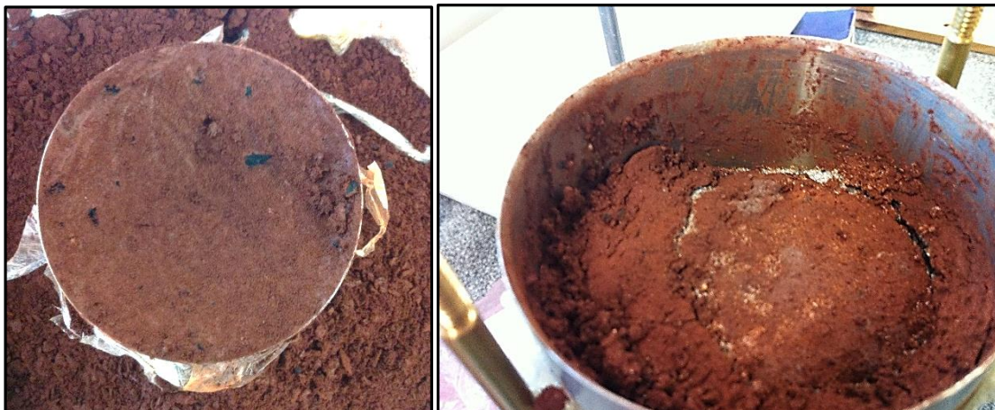
Figura 48 – Coluna 1 pré oxidação na base da coluna (esquerda) fissuras no solo da Coluna 1 pós oxidação no topo da coluna (direita).
