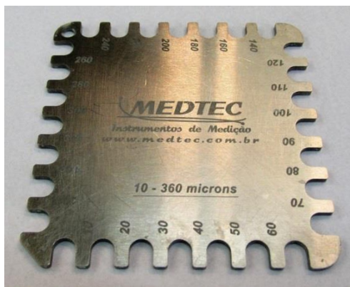
Figura 19 – Medidor de camada úmida do tipo pente da marca Medtec, de modelo MED-360
