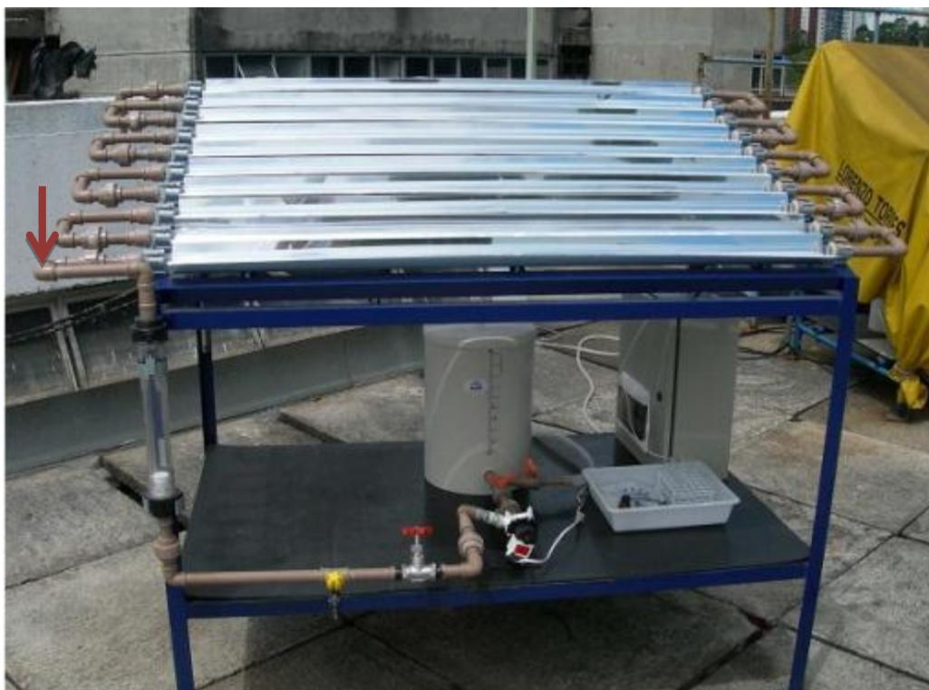
Figura 3.1 – Reator CPC existente no CESQ que será modelado - Vista frontal do reator. (RIBEIRO, 2009)
