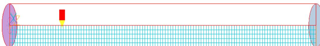
Figura 4.32 – Malha 2, com 600 elementos, selecionada para simulações do tubo reto cilíndrico.
