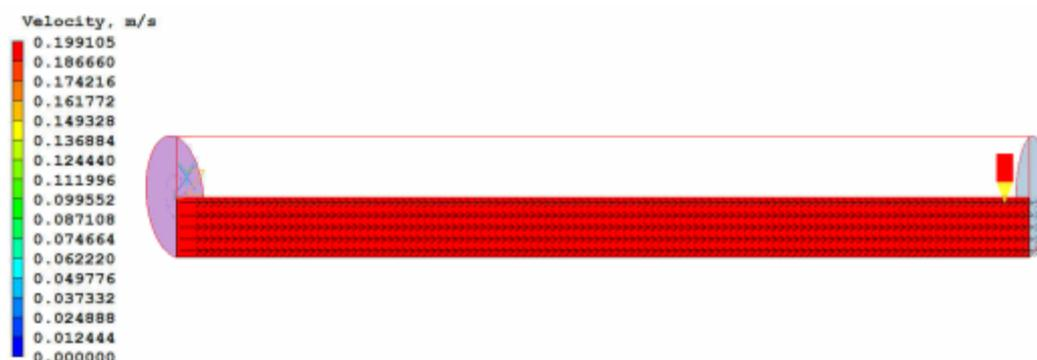
Figura 4.42 – Campo de velocidades para o escoamento *plug-flow*, vazão de  $8 \text{ L}\cdot\text{min}^{-1}$ , utilizando a malha 2 selecionada, para o tubo reto cilíndrico.
