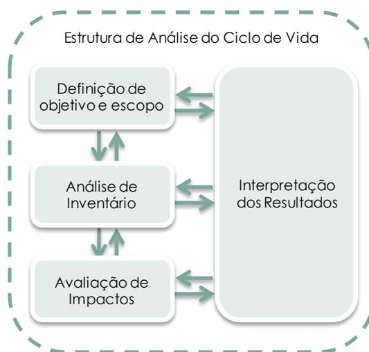
**Figura 10: Estágios do estudo de ACV (adaptado da norma ABNT NBR ISO 14040, 2009).**
