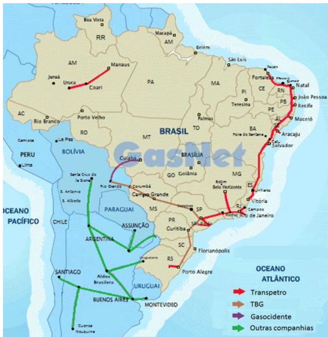
Figura 17: Gasodutos em operação (GASNET, 2013).
