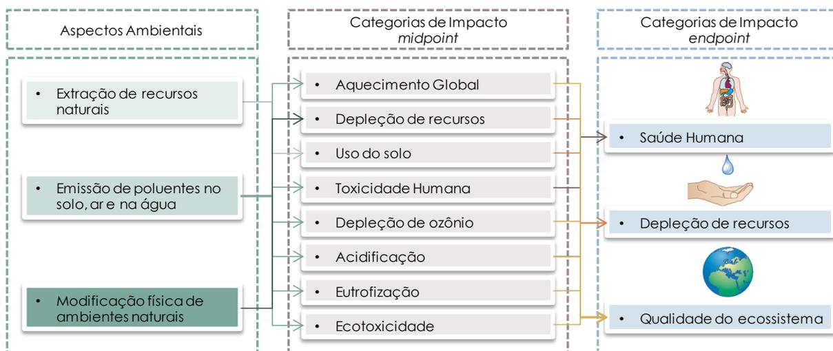
**Figura 12: Fluxograma esquemático da classificação dos aspectos em categorias de impacto (adaptado de UNEP, 2011).**
