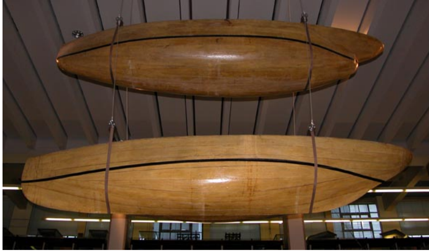
Figura 2.2: Modelos swan ( cisne ) e raven ( corvo ) utilizados por Willian Froude para estudar problemas de escala e de resistência ao avanço. Foto tirada por William M. Connelly e disponível em www.commons.wikimedia.org
