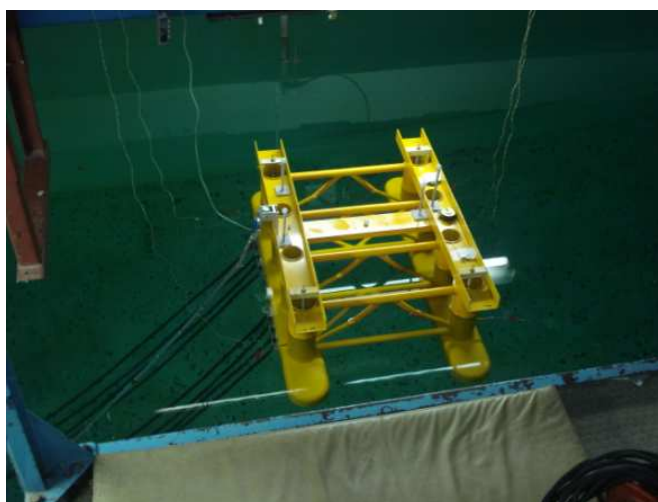
Figura 27 Configuração do ensaio com risers
