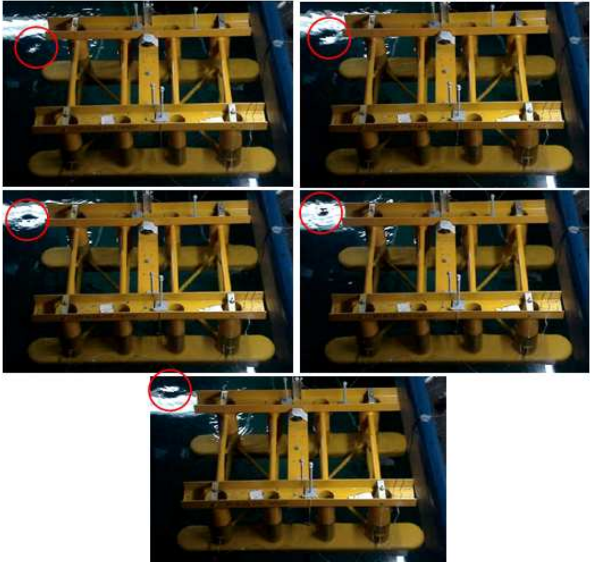
Figura 67 Série de figuras, retirada de vídeo do ensaio, mostrando formação de vórtices
