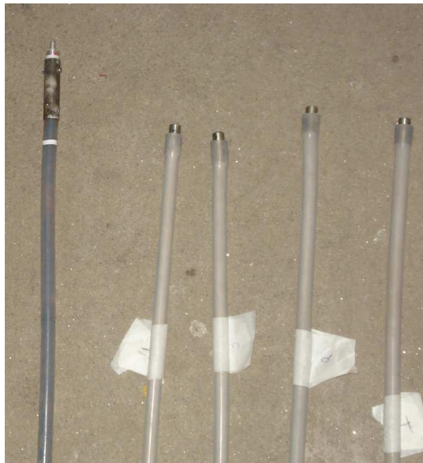
Figura 45 Detalhe do topo dos risers utilizados no ensaio
