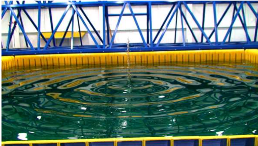
Figura 1.1: Calibrador Hidrodinâmico, tanque de provas construído na Universidade de São Paulo.
