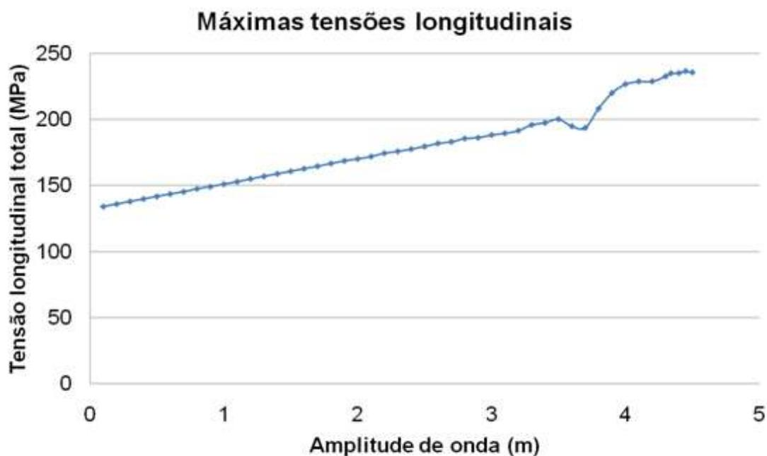
Figura 7-18 Máximas tensões longitudinais em função da amplitude de onda
