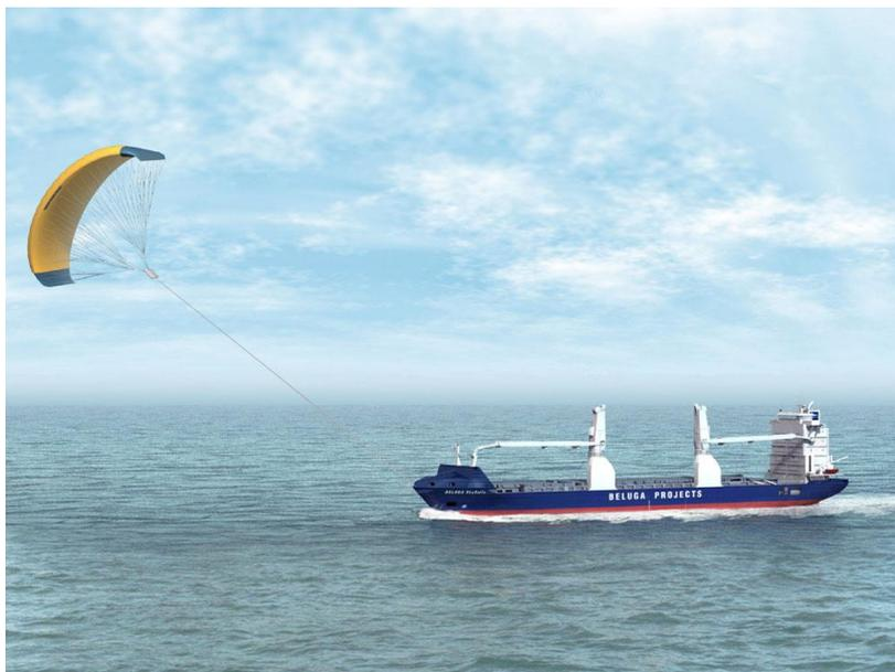
**Figura 4.10** Plataforma tipo pipa aproveitada pela companhia SkySails
