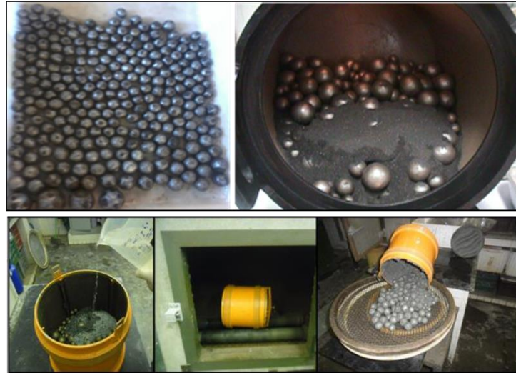
Figura 39. Operação da moagem em moinho de bolas em escala de bancada
