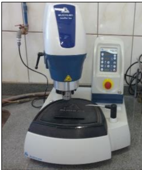
Figura 42. Politriz modelo Buehler Automet 250 utilizada para o polimento das amostras
