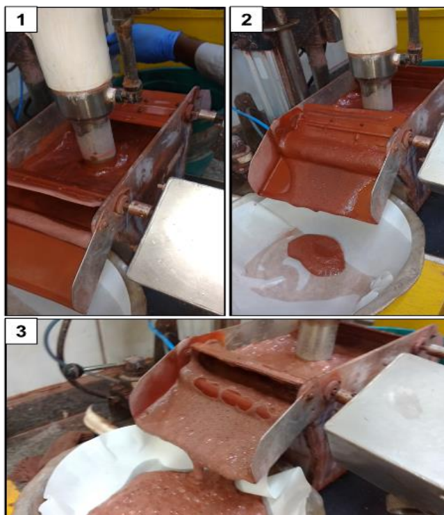
Figura 46. 1 - Acionamento do ar; 2 - Início do processo de retirada de espuma; 3 – Etapa final de flotação com espuma exaurida
