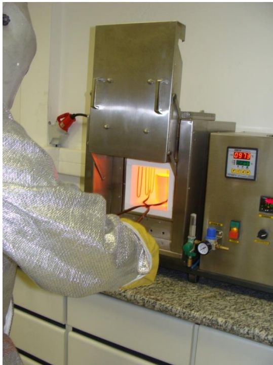
Figura 14 – Tratamento térmico das pelotas verdes
