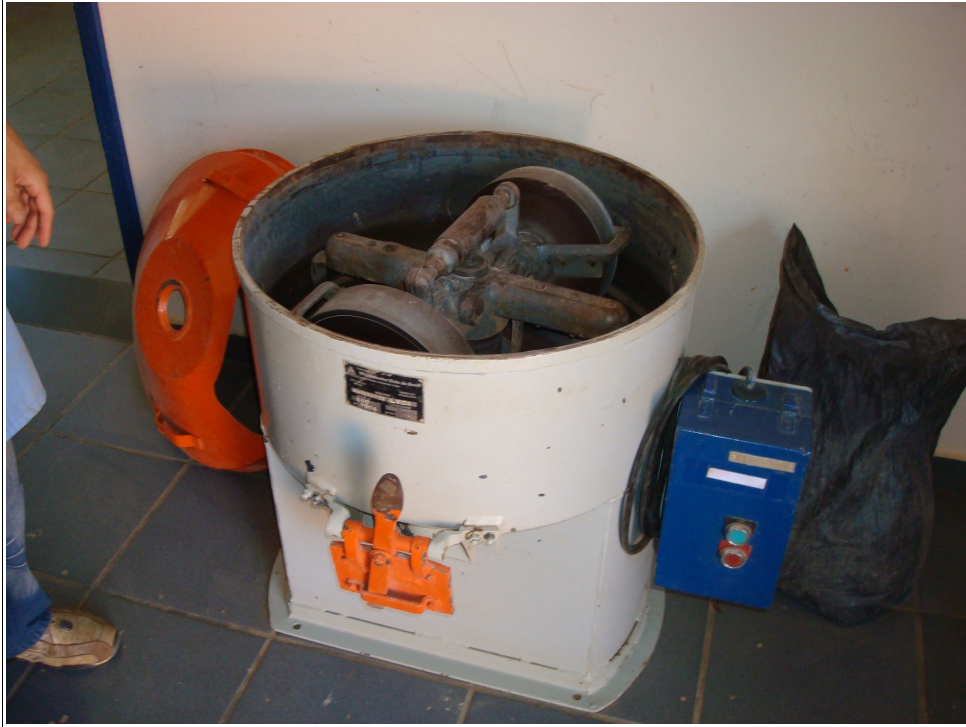
Foto 3.25 – Galga. Equipamento utilizado para preparação da massa. (Foto: autor).
