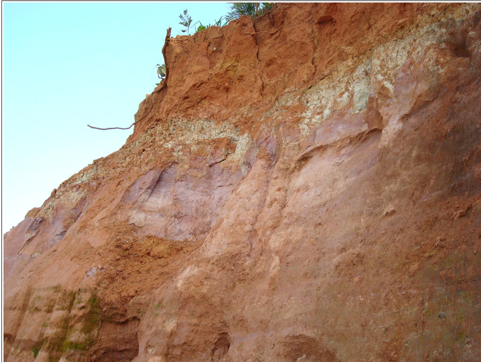
Foto 3.7 – Seqüência da base para o topo: argila roxa, argila cinza esverdeada e solo de alteração argiloso laterítico. (Foto: autor).
