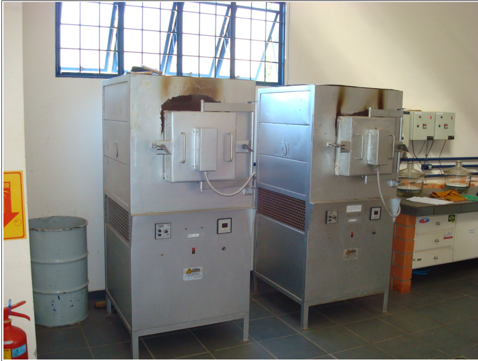
Foto 3.29 – Fornos elétricos para realização da queima dos corpos de prova. (Foto: autor).
