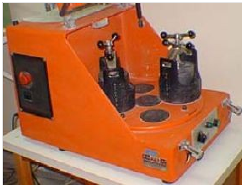
Foto 3.23 – Moinho de bolas tipo planetário, usado na preparação das amostras para o difratômetro. Fonte: Kahn(2005).
