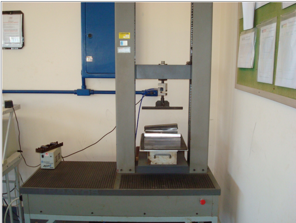
Foto 3.28 – Máquina universal de ensaio, utilizada para realização dos ensaios à flexão. (Foto: autor).
