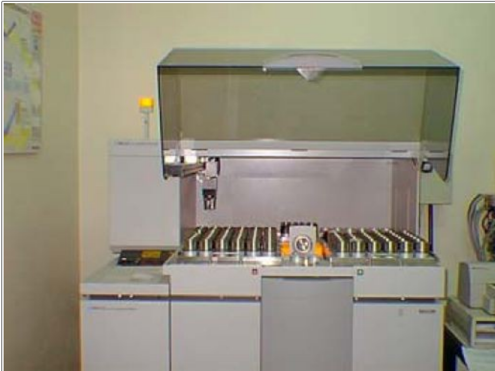
Foto 3.22 – Espectrômetro de dispersão (WDS) utilizado nas análises químicas. Fonte: Kahn(2005)
