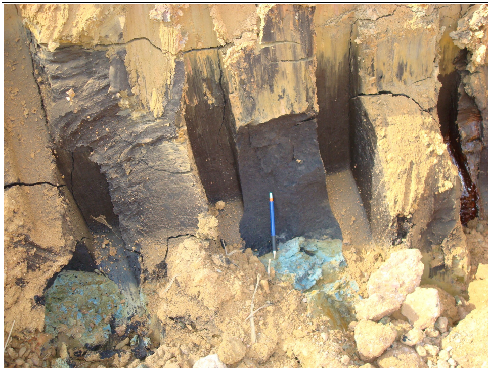
Foto 3.8 – Argila com alta concentração de matéria orgânica, sobre camada de argila de coloração azul. (Foto: autor).
