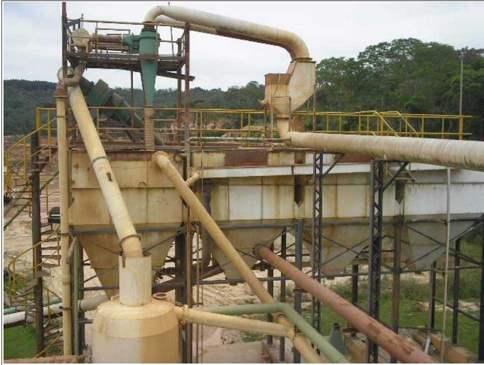
Foto 3.11 – Hidrociclones, onde o material mais fino é separado da areia. (Foto: autor).
