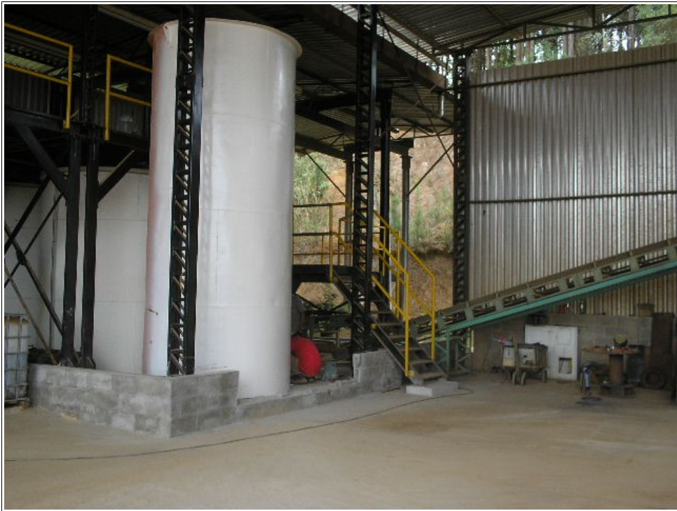
Foto 3.16 – Correia transportadora da argila obtida no final do processo. (Foto: autor).
