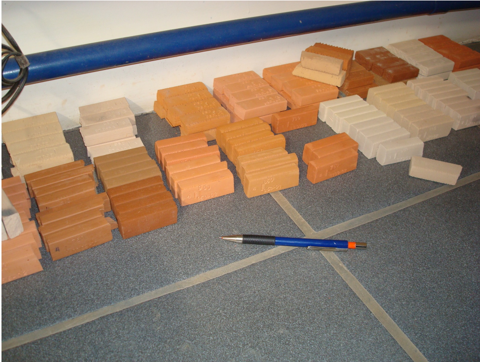
Foto 3.27 – Corpos de prova utilizados nos ensaios cerâmicos. (Foto: autor).
