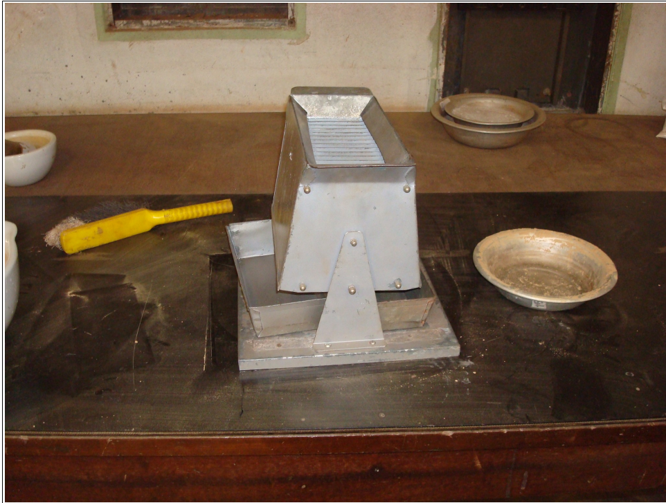
Foto 3.20 – Amostrador Jones utilizado para separação das amostras para os ensaios de caracterização. (Foto: autor).
