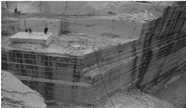
Foto.1.3 Frente de lavra da pedreira de mármore de Vargem Grande do Soturno.
