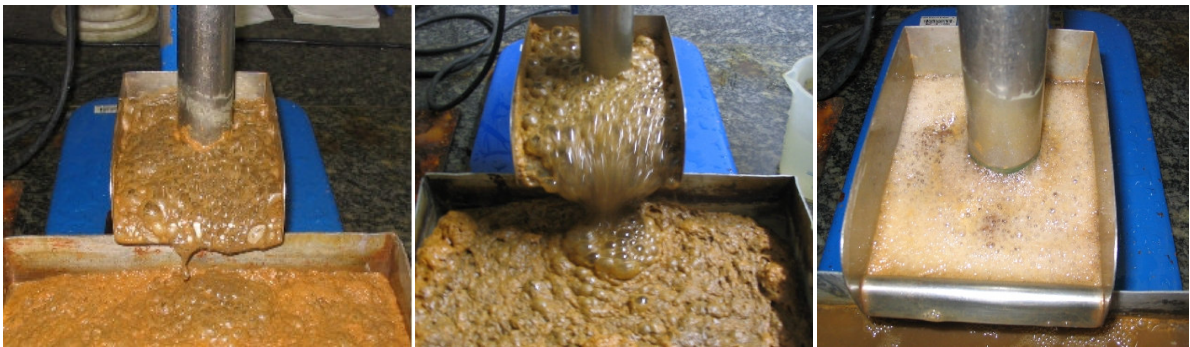
Figura 17 - Etapas “ rougher ”, “ cleaner ” e “ scavenger ” da flotação reversa
