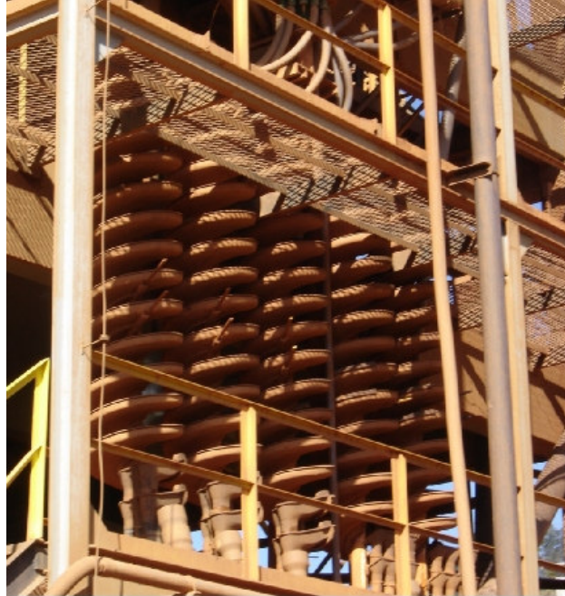
Figura 8 - Espirais concentradoras do circuito de finos do minério anfíbolítico
