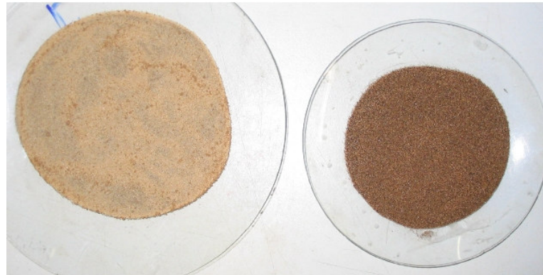
Figura 25 - Flotado e deprimido antes da separação magnética
