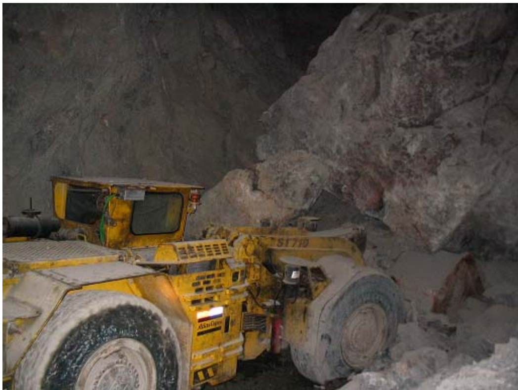
Figura 3.5 – Queda de rochas sobre a caçamba do scooptram (Fotografias da minera Condestable – Peru)
