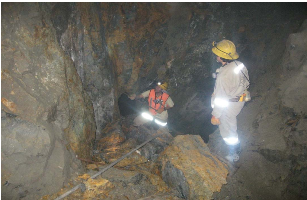
Figura 3.10 - Queda de rochas em escavações subterrâneas (Fotografia do autor na mina Condestable - Peru)
