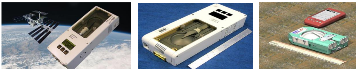
Figura 1. Nariz eletrônico usado pela NASA. Seu tamanho é de 12 polegadas (cerca de 30,5 cm.) de comprimento. É capaz de alertar os astronautas da ocorrência de qualquer vazamento de contaminantes ou de substâncias nocivas, obrigando os astronautas a usarem aparelhos de respiração. Informa quando o sistema de filtragem de ar voltar a funcionar e o ar está em condições seguras para respirar (NASA, 2010).
