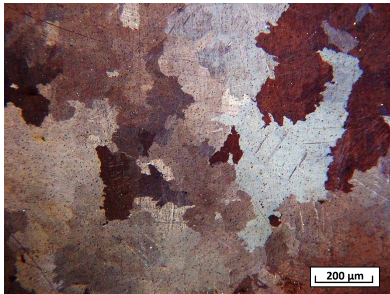
Figura 45: Micrografia ótica de luz polarizada do urânio puro no estado bruto de fundição. Ampliação 100x.
