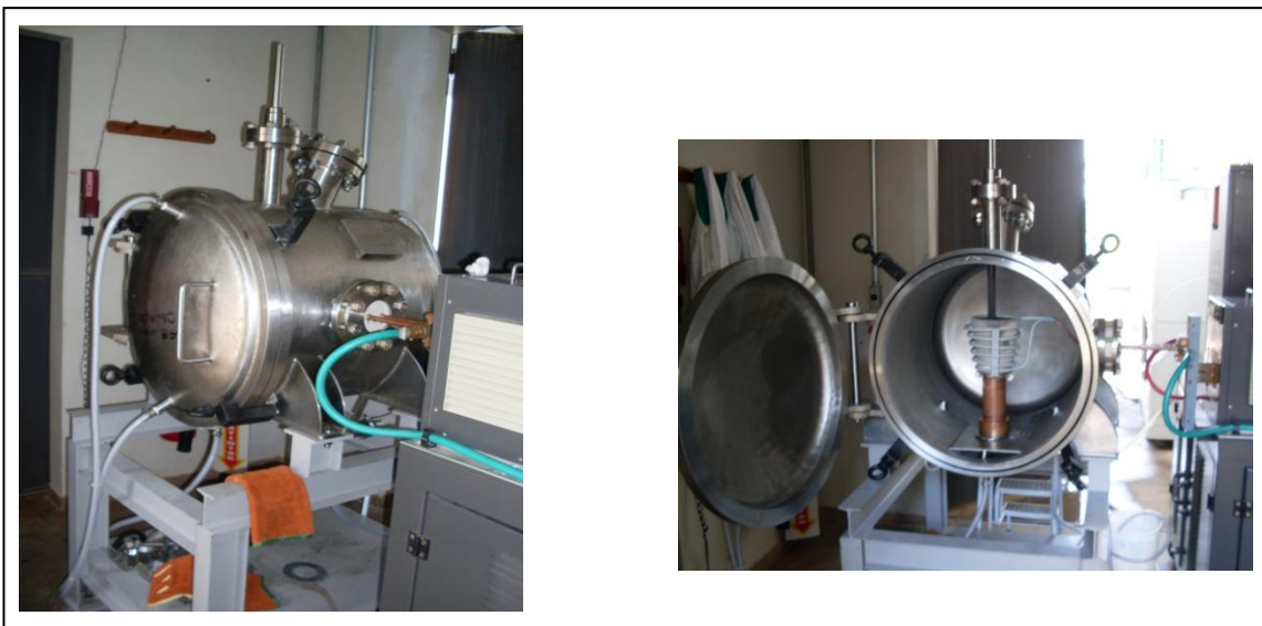
Figura 42: Forno indução. Detalhes câmara de fusão, arranjo do cadinho (grafite) sobre a coquilha de cobre e lança para sistema de fundição.
