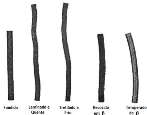
Figura 12: Efeito da ciclagem térmica (850 ciclos) entre 50 °C e 600 °C no urânio \alpha . Barras de diâmetro de 25 mm e comprimentos iniciais iguais [39].
