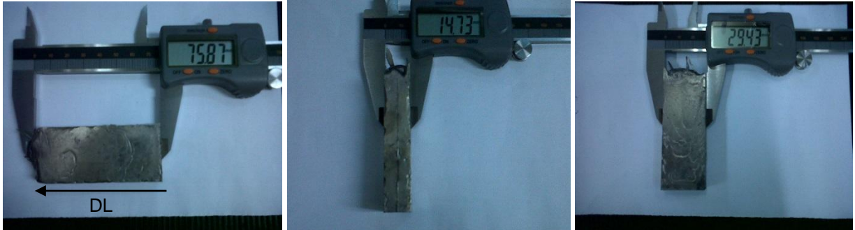
Figura 43: Placa obtida por lingotamento após fusão no forno a indução.
