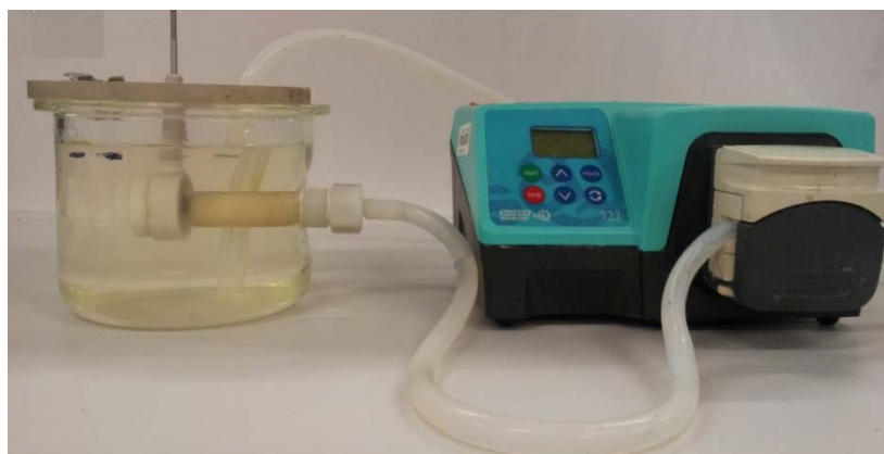
Figura 4.5 – Bomba peristáltica e montagem empregados nos ensaios de erosão – corrosão
