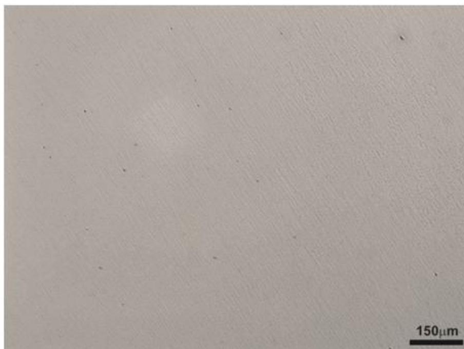
**Figura 75** Superfície do tubo RS-X65S após ensaio de HIC, solução A. Polimento: 1 $\mu$ m, sem ataque. Aumento: 100X. MO.
