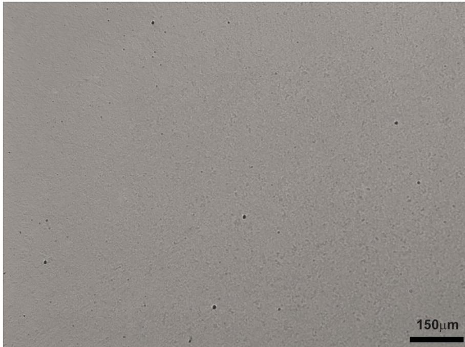
**Figura 36** Distribuição das inclusões no tubo API 5L X65 sour. Polimento 1μm sem ataque. Classificação das inclusões: nível D1. Aumento: 100X. MO. Seção examinada conforme recomendação na norma ASTM E45.
