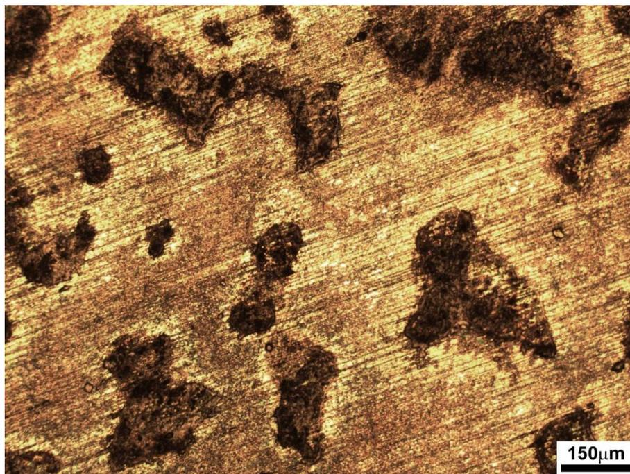
**Figura 68** Morfologia da corrosão RS-X65S. Corrosão uniforme com de corrosão localizada.
