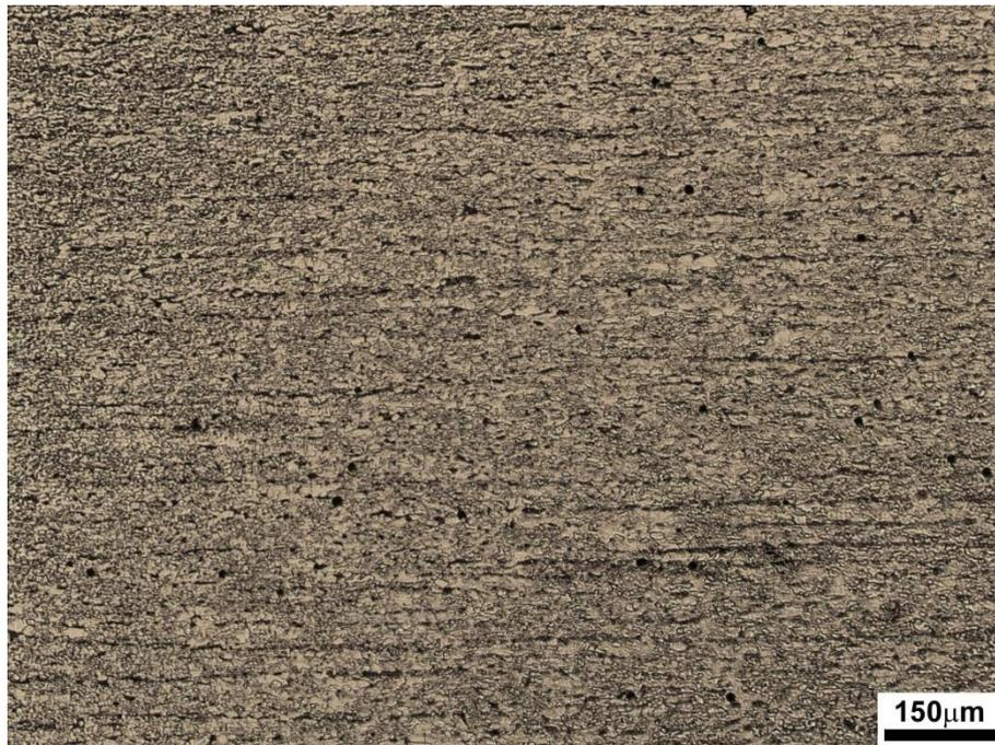
**Figura 50** T-X65NS: Microestrutura da região central da seção transversal do tubo API 5L X65 não-sour. Nota-se bandeamento. Ataque: nital 2%. Aumento:100x. MO.
