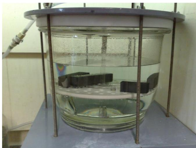
**Figura 34** Detalhe da célula durante o período de imersão dos corpos-de-prova nos eletrólitos contendo H<sub>2</sub>S.
