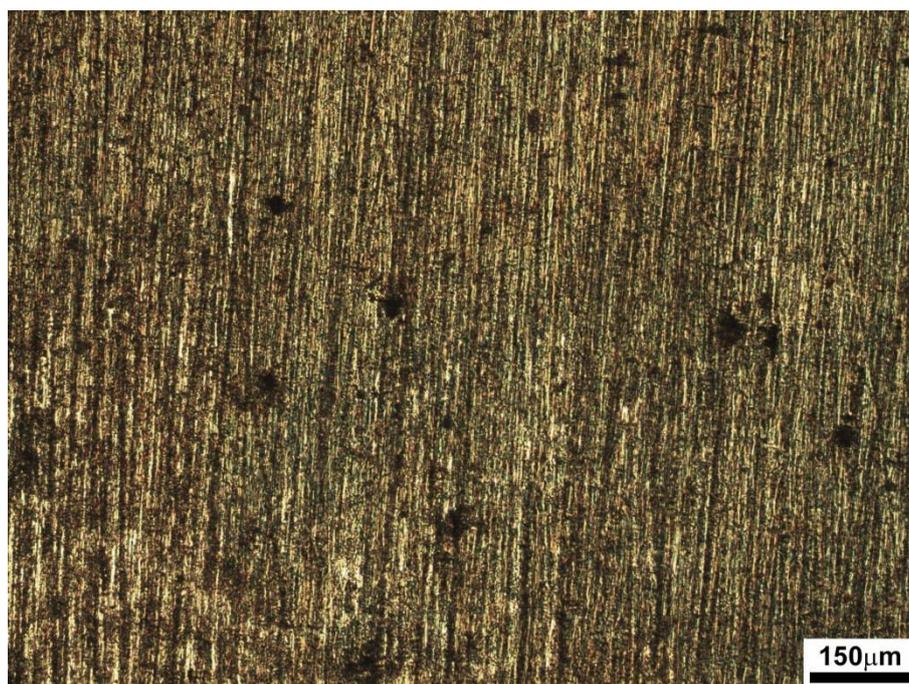
**Figura 62** Morfologia da corrosão C-X65. Corrosão uniforme com nível médio de corrosão localizada. Solução A. Aumento: 100X. MO.
