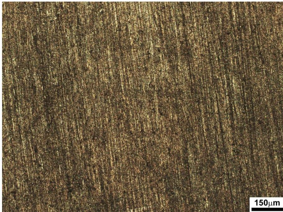
**Figura 60** Morfologia da corrosão RS-X65S. Baixa corrosão uniforme, baixo nível de corrosão localizada. Solução A. Aumento: 100X. MO.
