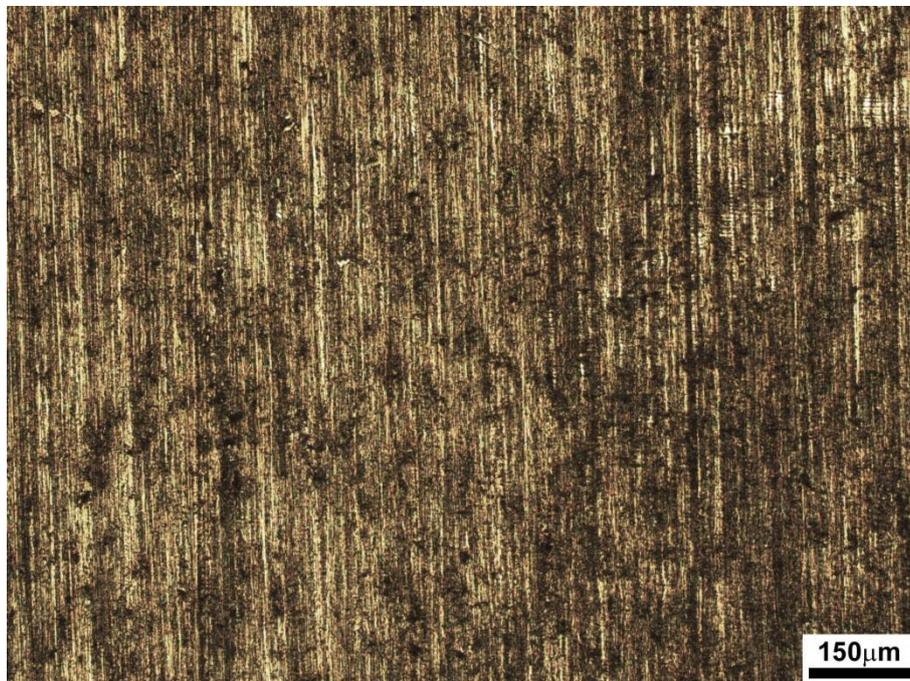
**Figura 58** Morfologia da corrosão T-X65S. Pouca Corrosão uniforme, com baixo nível de corrosão localizada. . Solução A. Aumento:100X. MO.
