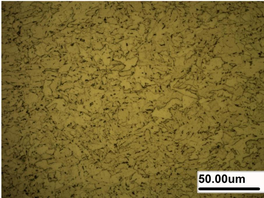
**Figura 45** T-X65S: Microestrutura da região central da seção transversal do tubo. Ataque: nital 2%. Aumento: 500x. MO.
