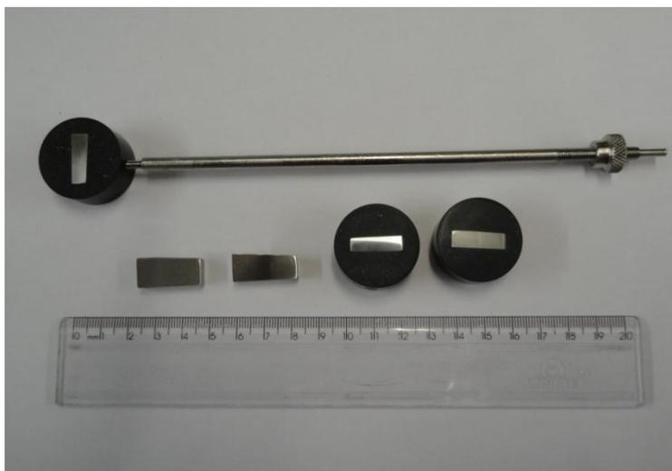
**Figura 28** Corpos-de-prova antes e após embutimento.
