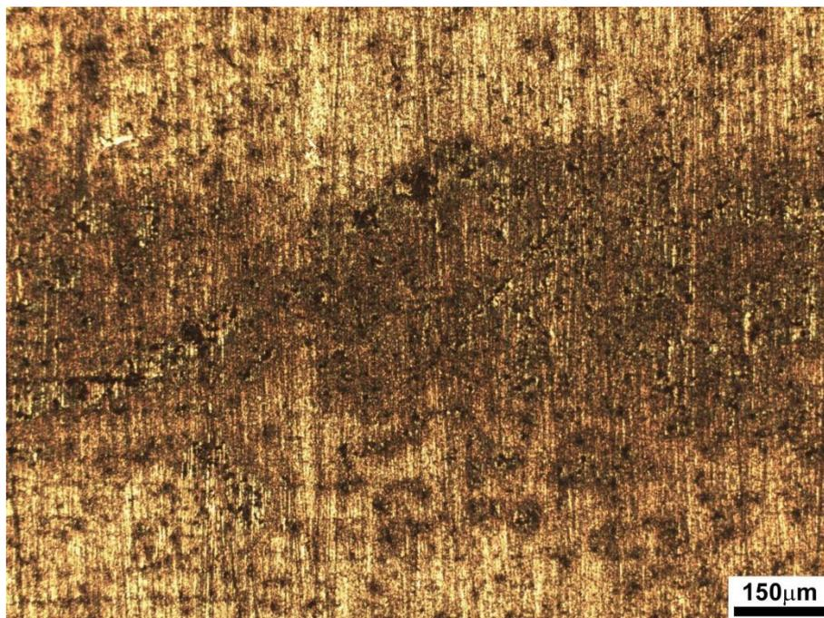
**Figura 64** Morfologia da corrosão T-X65NS. Intensa corrosão uniforme com alto nível de corrosão localizada. Solução A. Aumento: 100X. MO.
