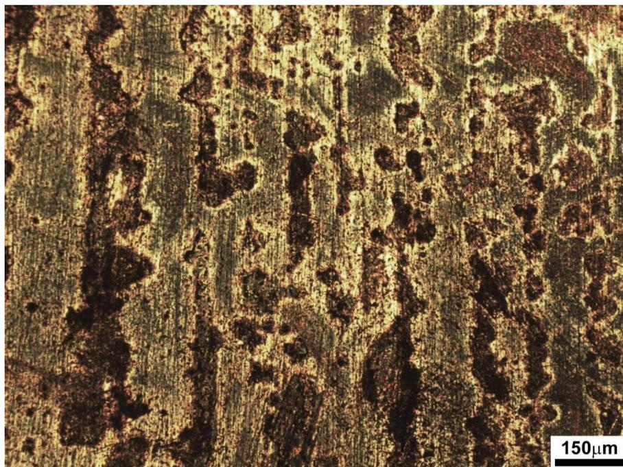
**Figura 72** Morfologia da corrosão T-X65NS. Corrosão uniforme com corrosão localizada. Solução B. Aumento: 100X. MO.
