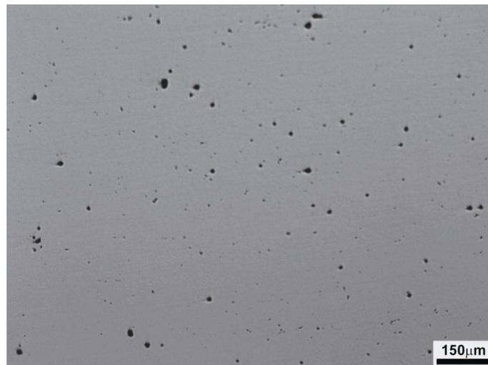
**Figura 42** Distribuição das inclusões para o tubo API 5L X65 não-sour (T-X65NS). Polimento: 1 $\mu$ m, sem ataque. Classificação das inclusões: nível D4. Aumento: 100X. MO. Seção examinada conforme recomendação na norma ASTM E45.
