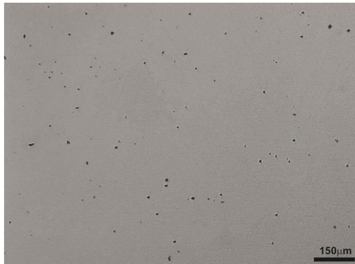
**Figura 40** Distribuição das inclusões na chapa para tubo API 5L X65 (C-X65). Polimento: 1 μm, sem ataque. Classificação das inclusões: nível D3. Aumento: 100X. MO. Seção examinada conforme recomendação na norma ASTM E45.
