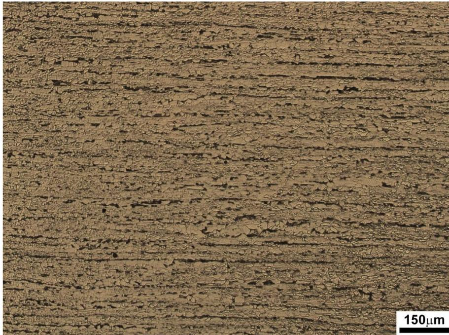
**Figura 48** C-X65: Microestrutura da região central da seção transversal da chapa para tubo API 5L X65 sour. Nota-se estrutura bandeada de ferrita e perlita. Ataque: nital 2%. Aumento:100x. MO.
