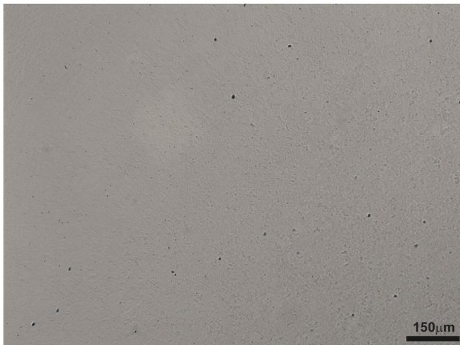
**Figura 74** Superfície do tubo T-X65S após ensaio de HIC, solução A. Polimento: 1 $\mu$ m, sem ataque. Aumento: 100X. MO.
