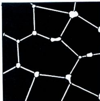
Figura 12 - Exemplo das alterações que ocorrem durante o estágio final da sinterização.
