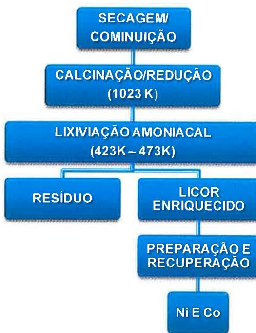
Figura 3.3: Estrutura do processo Caron dando origem ao resíduo de estudo.
